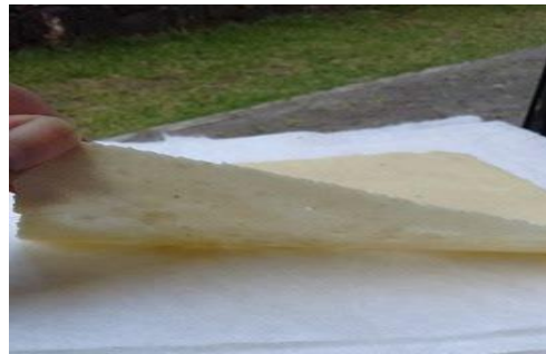
Figura 16. Secado final de la hoja de papel ya con bajo contenido de humedad
