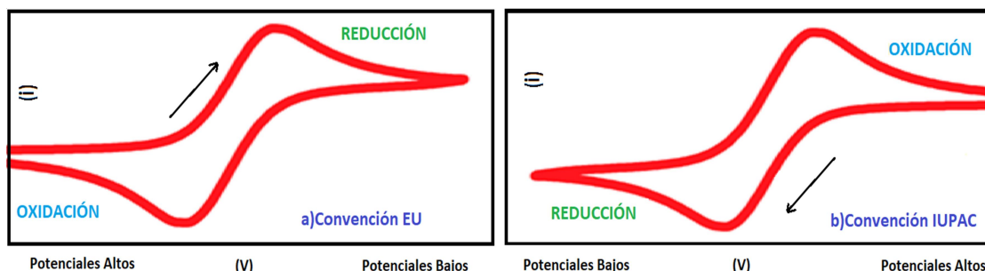
Figura 6 Dos convenciones son usadas para reportar datos de voltamperometría cíclica: la convención de Estados Unidos (izq) y la convención internacional (der). Visualmente los datos reportados en las dos convenciones aparecerán rotados en 180^\circ .
