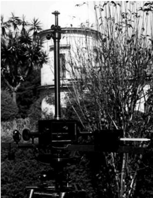
Figura 1.4 Magnetómetro unifilar para la medición de la Intensidad Horizontal del Campo Magnético Terrestre mediante el método de Oscilaciones (acervo fotográfico del Observatorio Magnético de Teoloyucan)
