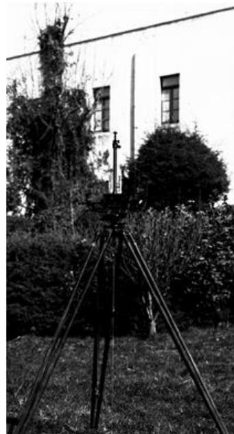
Figura 1.5. Magnetómetro unifilar para la medición de la Intensidad Horizontal del Campo Magnético Terrestre con trípode para prospección de campo (acervo fotográfico del Observatorio Magnético de Teoloyucan)
