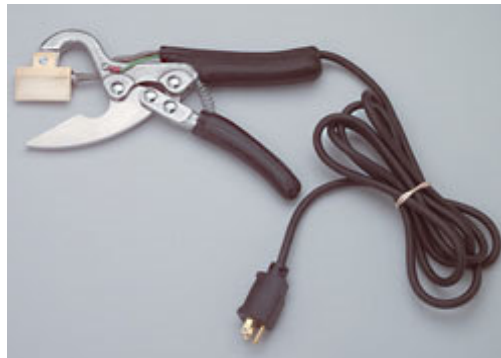
Figura 11.- Descolador eléctrico (tomado de http://www.sheep101.info/201/dockcastrate.html )
