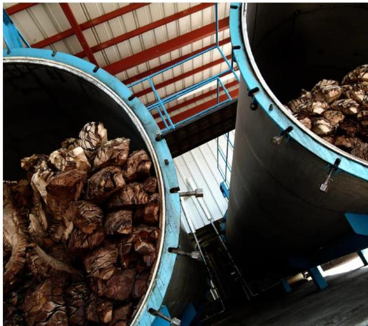
**Figura 15. Autoclaves cargadas con piñas de agave azul en Real de Jalpa.**
