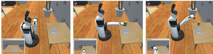
Figura 6.19: El robot coloca los objetos autónomamente usando la representación virtual de los objetos
