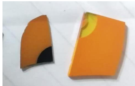
Figura 84. Fotografía donde se aprecia la coloración que tomaron los sustratos sintetizadas con nanoalambres de compuestos de silicio.
