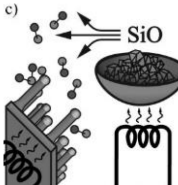
Figura 17. Esquema del proceso de evaporación de SiO [60].
