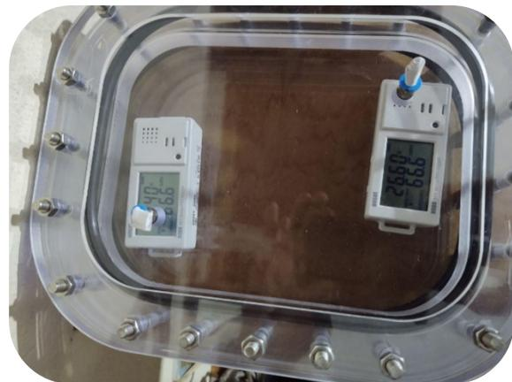
Figura 47 - Prueba 1.2 -Cápsula sellada con dos puntos de sensado
