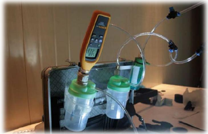
Figura 6 - Prototipo de sistema de humidificación
