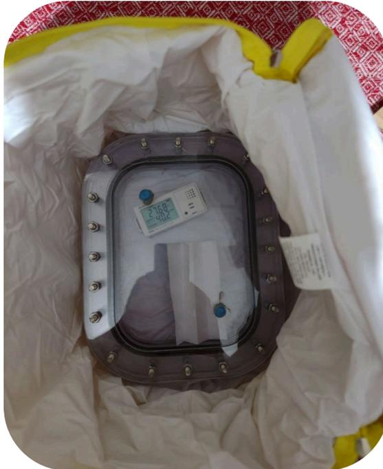
Figura 89 - Aislamiento térmico para prueba 6.2
