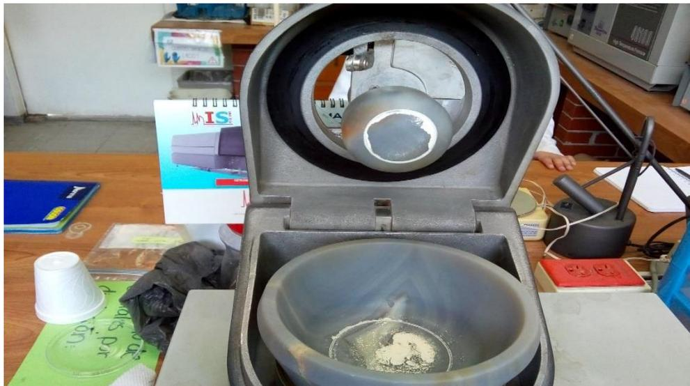
**Fig. 35.** Método de trituración en seco (molino mecánico).
