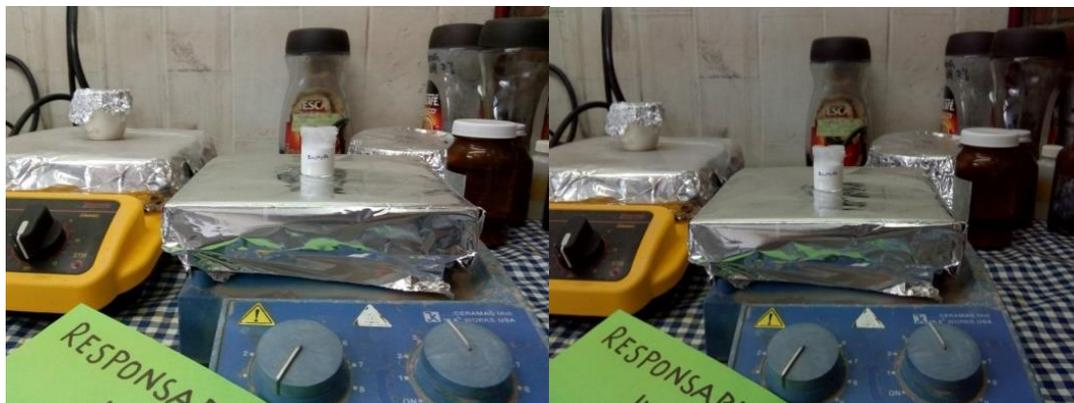
**Fig. 34.** Método de trituración en mojado (en metanol) a una velocidad de 480 rpm.
