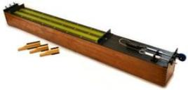
Se hace pulsar una cuerda tensada sobre una caja de sonido para demostrar la relación entre la frecuencia del sonido producido y la tensión, longitud y masa por unidad de longitud. Se manipulan puentes móviles para demostrar relaciones matemáticas entre las frecuencias producidas.
