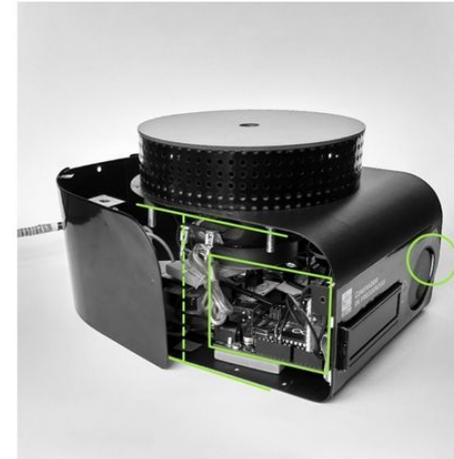
Al interior existen muchos cables y componentes que se enciman uno sobre otro. Esto pone en riesgo al usuario ya que puede ser un peligro de corto. Además, también se dificulta el flujo de aire, propiciando el sobrecalentamiento del dispositivo.
