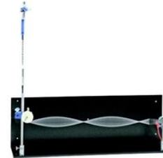
Se utiliza para la demostración de ondas estacionarias transversales en una cuerda y para el estudio de su longitud de onda en relación con la tensión y la frecuencia.
