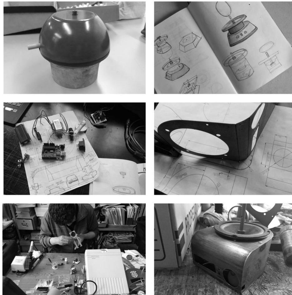
**Imagen 6.** Fotos de proceso: Prototipo original / Primeros bocetos para rediseño / Componentes electrónicos y planos / Carcasa metálica y planos / José Jesús Soto Figueroa ensamblando los componentes / Carcasa con bocina montada
