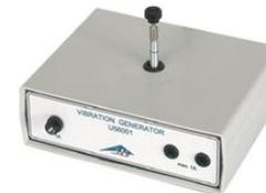
Se utiliza en conjunto con un generador de funciones para generar ondas mecánicas en el estudio de oscilaciones y resonancias. Está compuesto de un altavoz con un clavijero para la transmisión de oscilaciones. Se utilizan diversos accesorios para demostrar diferentes fenómenos.
