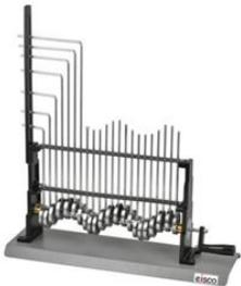
Se utiliza para demostrar movimientos de onda longitudinales y transversales. Consistente en una serie de discos excéntricos que soportan una serie de varillas metálicas que giran con una manivela.
