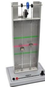
Diseñado para mostrar la vibración de un objeto cuando se aplican impulsos repetidos. Consta de dos pesos de diferentes frecuencias naturales. El control de velocidad se usa para ajustar la frecuencia de la fuerza aplicada para encontrar el punto de resonancia.
