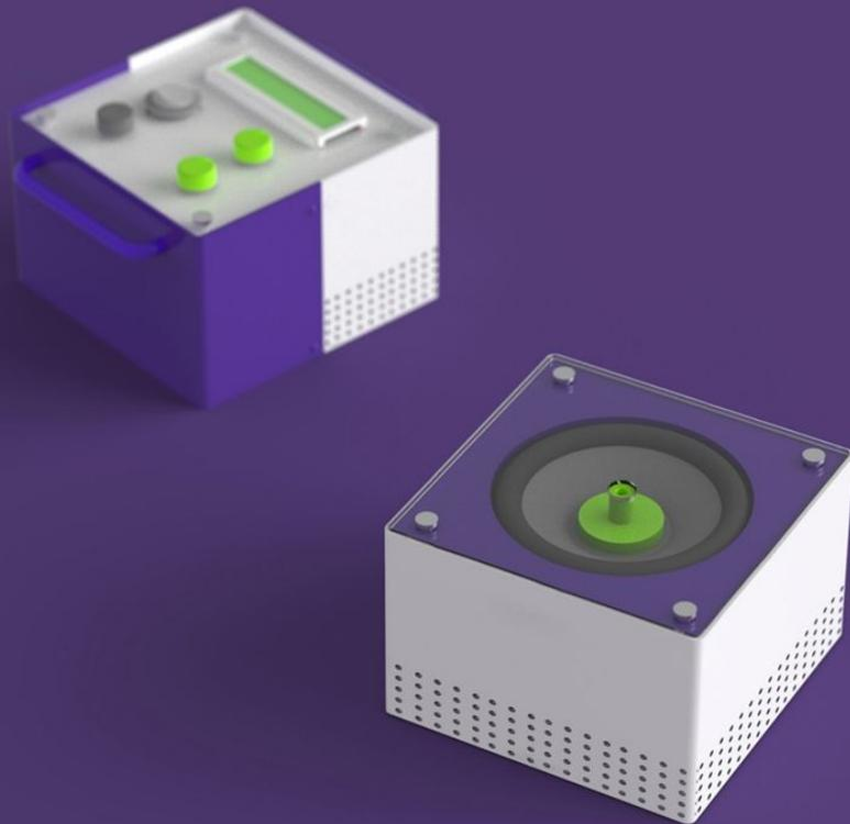
**Imagen 28.** Render de la segunda propuesta de rediseño para el generador de vibraciones y primer rediseño del generador de frecuencias.
