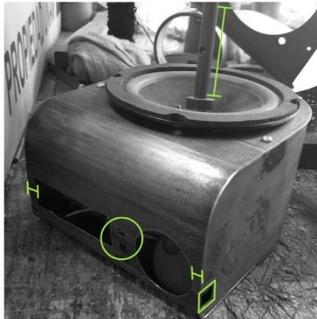
Para unir las dos partes de la carcasa se soldaron soportes a una de las partes. Sin embargo, perforarlos, soldarlos y alinearlos fue difícil y afectó la calidad final de los ensambles. Además, la soldadura dejó marcas visibles en el exterior de la pieza.
