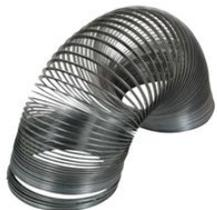
Sirven para generar ondas transversales y longitudinales que enseñen la relación entre la longitud de onda y la frecuencia. Se pueden utilizar para crear ondas estacionarias o en movimiento. La percepción del fenómeno depende del grosor y longitud del resorte.
