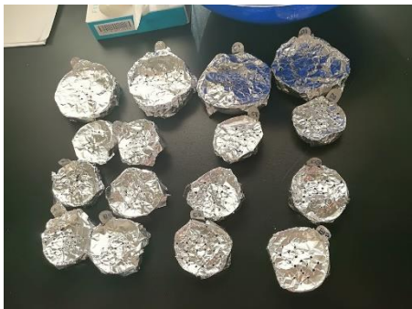
Figura 7. Charolas de aluminio con muestras para la determinación de humedad en las dietas experimentales, músculos y heces de juveniles de Litopenaeus vannamei colectados durante el bioensayo.
