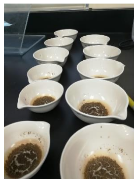
Figura 8. Muestras después de la calcinación en mufla a 550 °C para la determinación de cenizas en las dietas experimentales, músculo y heces de juveniles de Litopenaeus vannamei , colectados durante el bioensayo.
