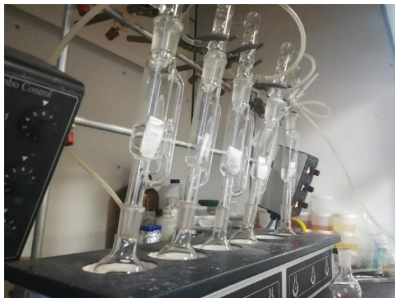
Figura 10. Determinación de lípidos en las dietas experimentales y músculos de juveniles de Litopenaeus vannamei colectados durante el bioensayo, utilizando el aparato de Soxhlet.
