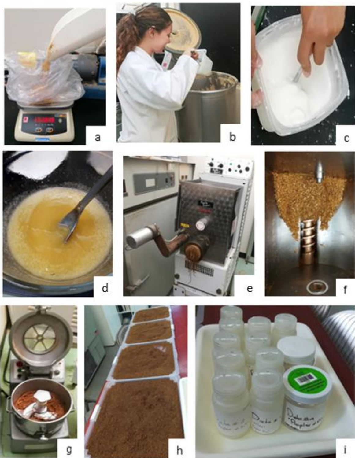
Figura 1. Proceso de preparación de las dietas formuladas con biomasa residual de la biosíntesis de treonina como fuente de proteína alternativa a la harina de pescado para el camarón Litopenaeus vannamei . (a) Pesaje. (b) Mezclado de ingredientes en una mezcladora de corte vertical. Preparación de (c) almidón; (d) grenetina. Masa en extrusor (e) saliendo y (f) dentro. Pellets (g) corte; (h) enfriado después del secado. (i) Envasado de las dietas.
