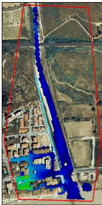
Figura 3- 20 Escenario de inundación sin obras de mitigación Después de haber obtenido el modelo digital de superficie, se tienen elementos para realizar este tipo de escenarios en los cuales se pueden identificar las zonas de falla en el río y determinar el área afectada, así como la altura del tirante de inundación.
