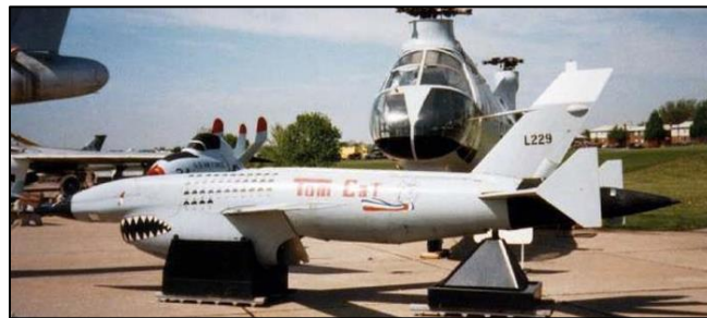
Figura 1- 7 Lightning Bug 147-J, aeronave no tripulada de reconocimiento del terreno, versión mejorada del 147-lightning-bug, aumentó su resolución y no dependía de la nubosidad.
