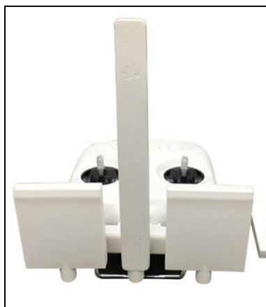
Figura 1- 17 Radio control con arreglo de antenas monopolo sin acoplamiento instalado.
