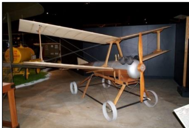
Figura 1- 1 Modelo Liberty Eagle Aerial Torpedo, peso 81 kg, 65 km de alcance. Tiempo de vuelo según la cantidad de combustible.
