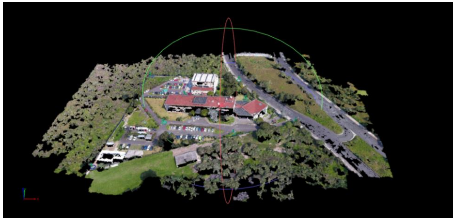
Figura 3- 1 Nube de puntos del CENAPRED. Reconstrucción de estructuras. Para mejorar la calidad y definición es marca con polígonos los edificios y vegetación, es decir, segmentar la nube de puntos.
