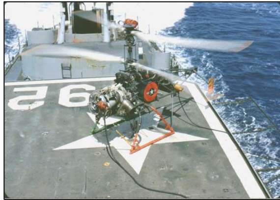
Figura 1- 8 HQ-50 fue la primera aeronave no tripulada de ala rotatoria, fue equipada con lanzagranadas, metralletas, modificaciones mecánicas, que le ocasionaron fallas en el vuelo.
