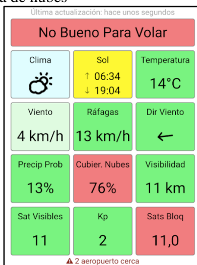
Figura 4 - 1 Además de indicarnos la lectura de diferentes variables para volar, hace una evaluación y nos indica si existen condiciones para un vuelo seguro y cuantos aeropuertos tenemos cerca.
