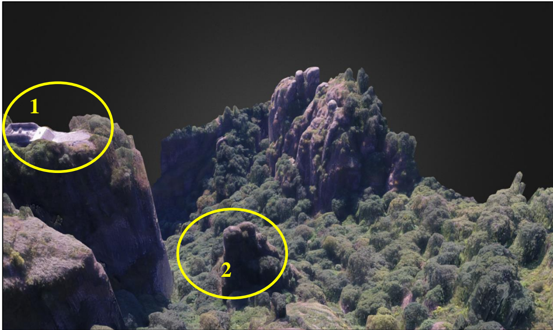
Figura 3- 6 delo 3D del cerro del Tepozteco, a la izquierda se puede observar la zona arqueológica del Tepozteco (1); en medio se observa el bloque de rocas “Los gemelos” (2), que están en riesgo de caída derivado del sismo del 19 de septiembre de 2017, lo que representa un riesgo para los visitantes, ya que se encuentra en el camino para llegar a la zona arqueológica.
