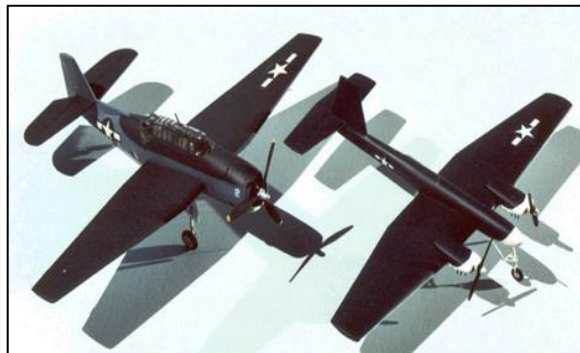
Figura 1- 3 TDR-1 fue una aeronave no tripulada que se controlaba desde un vuelo tripulado.
