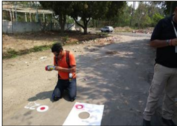
Figura 3- 39 Los puntos de control se marcan con aerosol cuyos colores contrasten para que sean ubicados en las imágenes aéreas.
