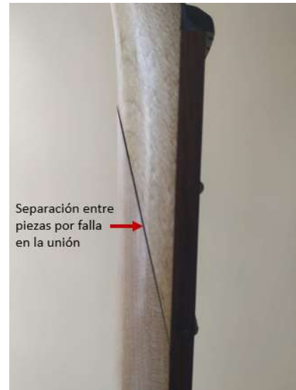
Figura 26 Falla en la unión de piezas de un mástil de dos piezas anguladas
