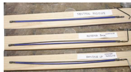
Figura 21 Almas de guitarra eléctrica
