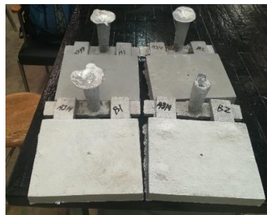
Figura 24. Molde adaptado para la prueba de análisis térmico de la aleación A319 y placas obtenidas de la aleación A319.
