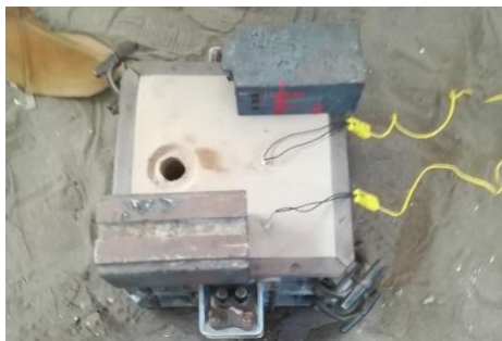
Figura 24. Molde adaptado para la prueba de análisis térmico de la aleación A319 y placas obtenidas de la aleación A319.
