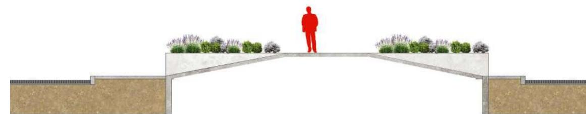
fig. 5.11: Diagrama en corte del cruce peatonal
