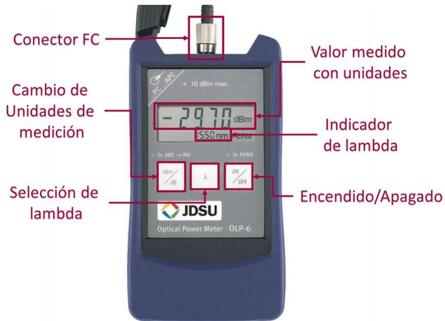
Figura 82 Indicadores y elementos del Power Meter.
