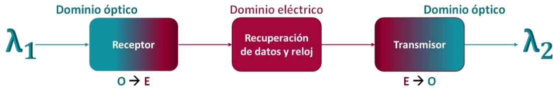
Figura 49 Diagrama de bloques de un transpondedor optoelectrónico.
