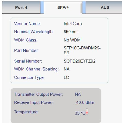
Figura 91 Lectura de la potencia óptica del SFP+ CH29-A a través del PL-1000TE.
