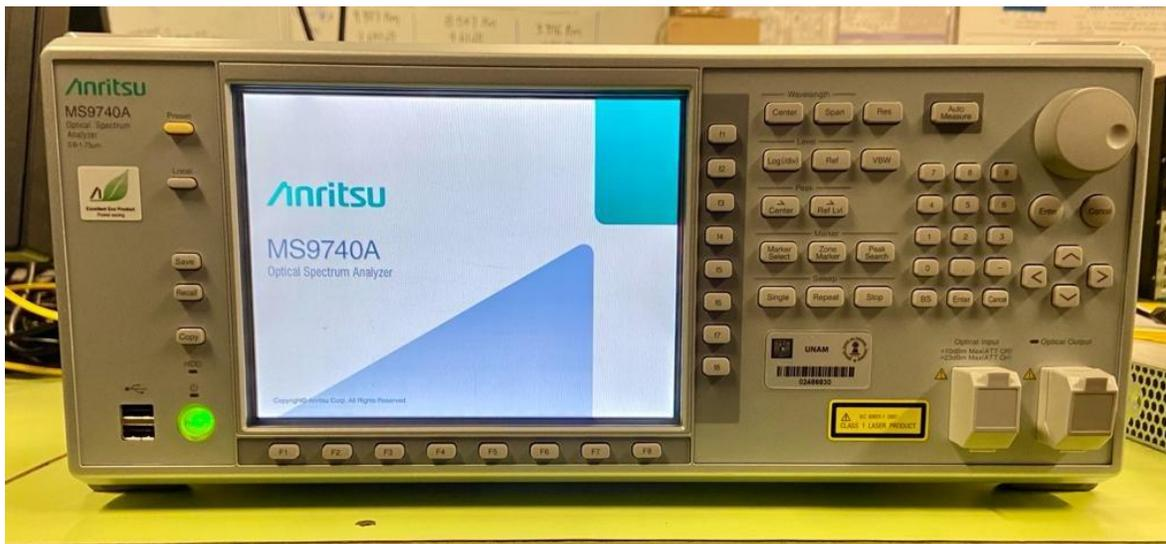
Figura 84 Analizador de espectro óptico (OSA).
