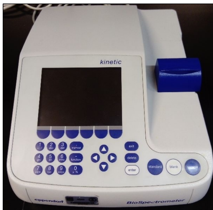
Figura 16. Espectrofotómetro UV-Vis BioSpectrometer, utilizado para la determinación de remoción del colorante carmín índigo.
