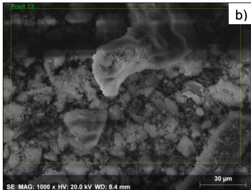
Figura 23. Análisis EDX-MEB de nZVI-DE-1. a) Espectro de difracción de energía dispersa por rayos X y elementos presentes en la muestra del material nZVI-DE-1 y b) Micrografía del área de análisis del material nZVI-DE-1, realizado por MEB.
