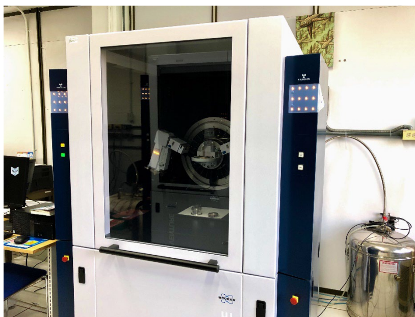
Figura 13. Difractómetro de Rayos X marca Bruker D8 Advance Eco, empleado para el análisis de rayos X.
