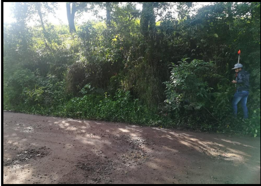
Imagen. 3.10. Uso del prisma necesario para capturar las coordenadas con la estación total.
