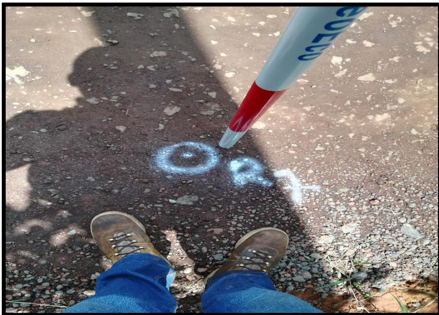
Imagen. 3.11. Marca de referencia necesaria para cambio de estación.
