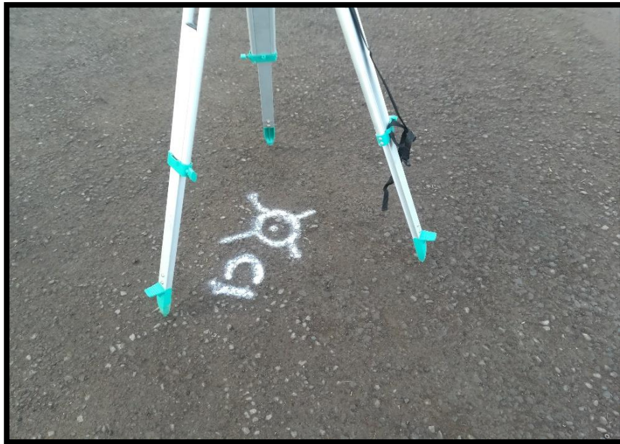
Imagen 3.9. Marca para identificar Cambio de estación necesario para el levantamiento topográfico
