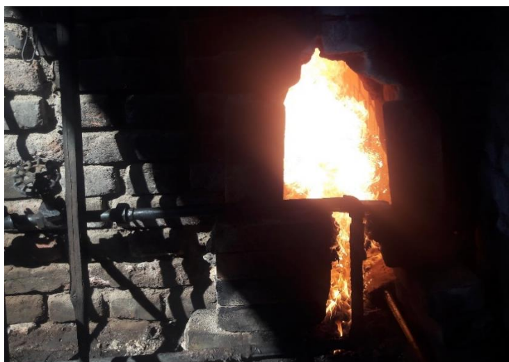
Figura 42: Quemador en operación en cámara de combustión de horno ladrillero Fuente: Imagen propia
