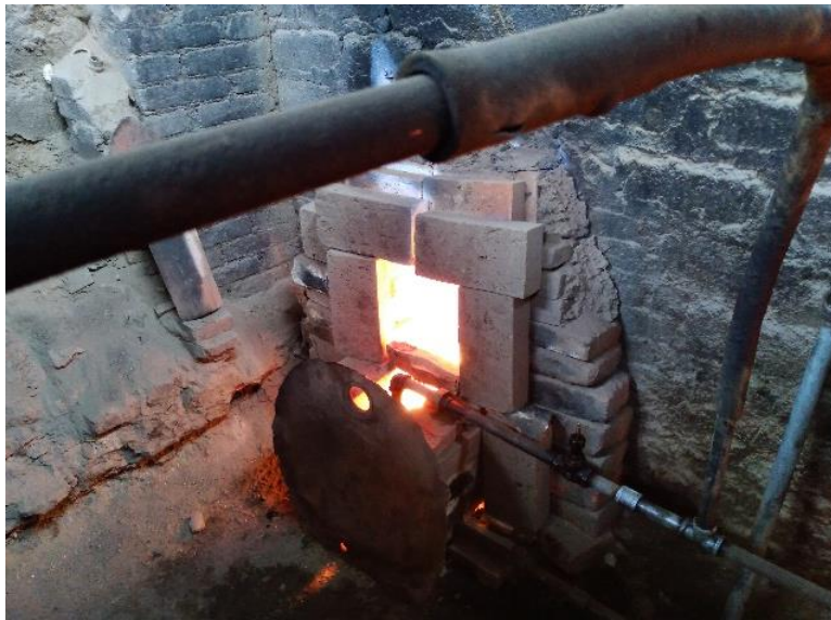
Figura 86: Horno que combustiona aceite de motor usado Fuente: Imagen propia
