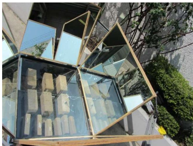
Figura 38: Horno solar para secado de ladrillos Fuente: Karupppasamy, 2019
