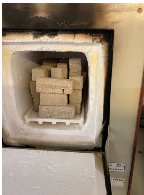
Figura 82: Muestras antes de iniciar el proceso en la mufla Fuente: Imagen propia
