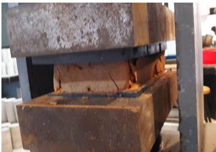
Figura 81: Ensayo de compresión, final de la prueba Fuente: Imagen propia
