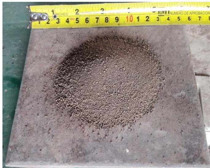
Figura 45: Arcilla tamizada Fuente: Imagen propia
