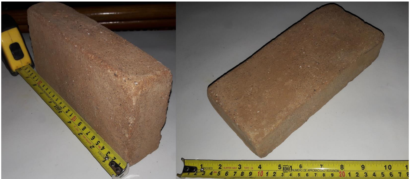
Figura 7: Ladrillo dentro de tolerancia a las despostilladuras Fuente: Imagen propia
