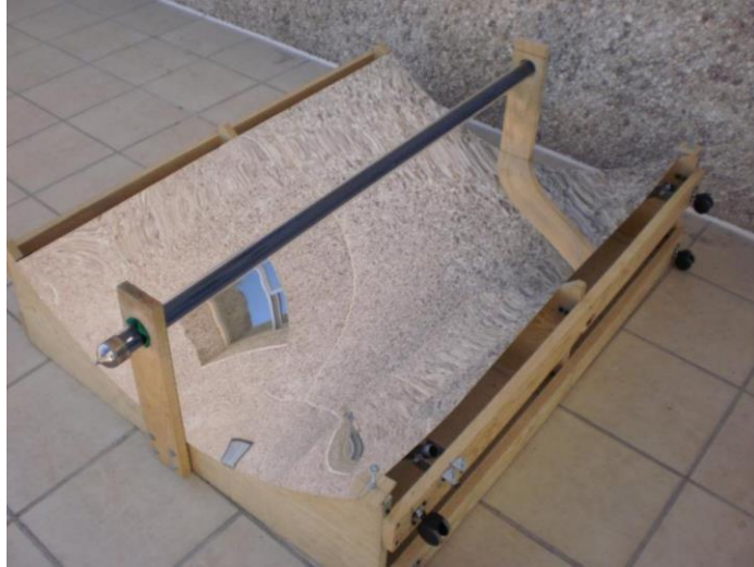
Figura 25: Concentrador solar cilíndrico para producir carbón vegetal Fuente: Ramos, G. y David Pérez, 2014
