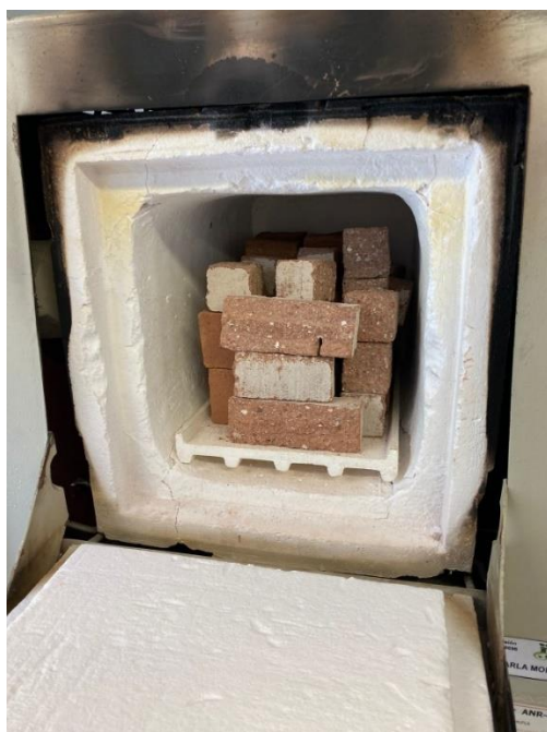
Figura 83: Muestras después de finalizar el proceso en la mufla Fuente: Imagen propia
