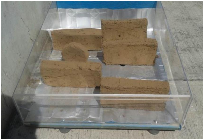
Figura 34: Secador solar para ladrillos de primera etapa Fuente: Aquino, 2015
