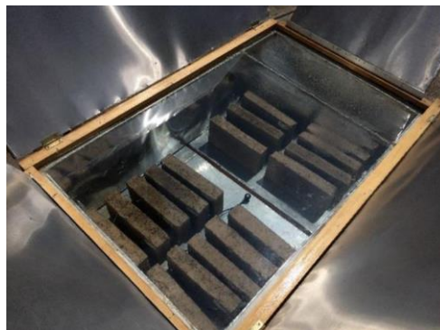
Figura 36: Secador solar para ladrillos Fuente: Rojas, et al. 2017
