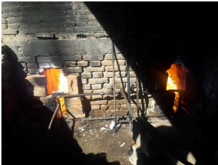
Figura 70: Quemadores de aceite Fuente: Imagen propia
