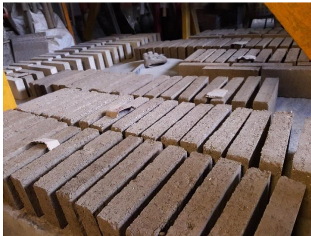
Figura 55: Acomodo de ladrillos que permite circulación de aire entre ellos Fuente: Imagen propia
