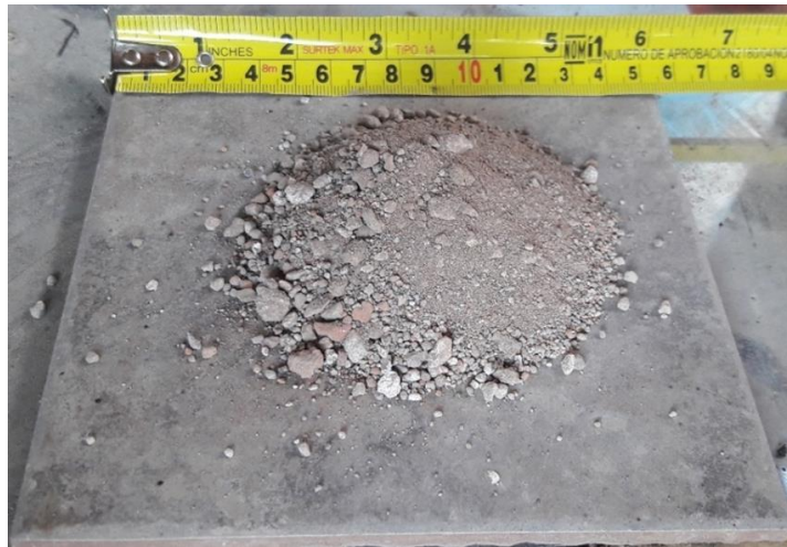
Figura 48: Reciclado de residuos de construcción todo en uno granulometría 1/4” Fuente: Imagen propia
