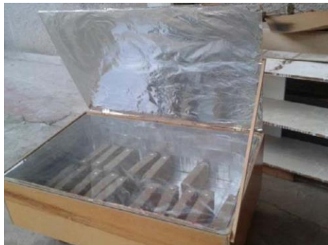
Figura 35: Secador solar (mejorado) segunda etapa Fuente: Aquino, 2015
