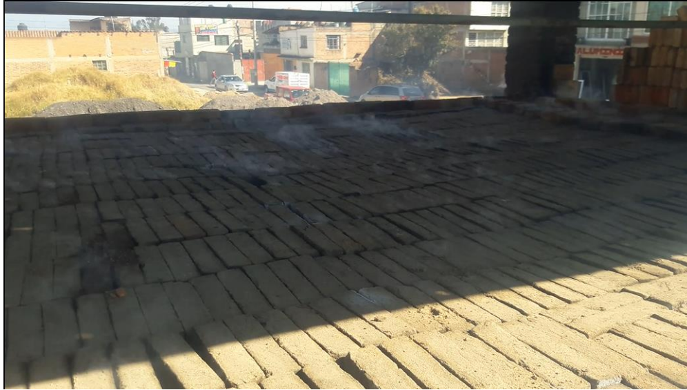
Figura 71: Horno ladrillero artesanal de tiro superior en operación Fuente: Imagen propia
