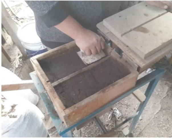
Figura 53: Exclusión de aire en la mezcla durante el moldeo Fuente: Imagen propia
