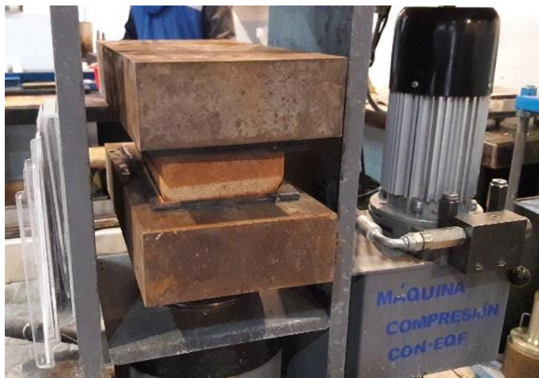
Figura 80: Ensayo de compresión, inicio de la prueba Fuente: Imagen propia
