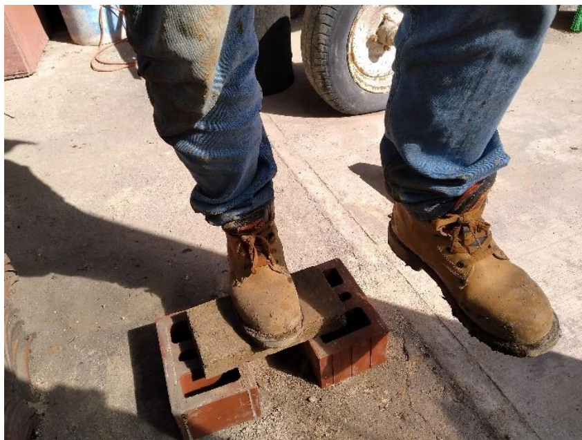
Figura 73: Prueba de calidad para adobes Fuente: Imagen propia
