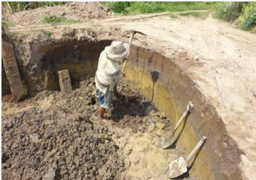
Figura 10: Extracción de arcilla Fuente: Sántis, 2013
