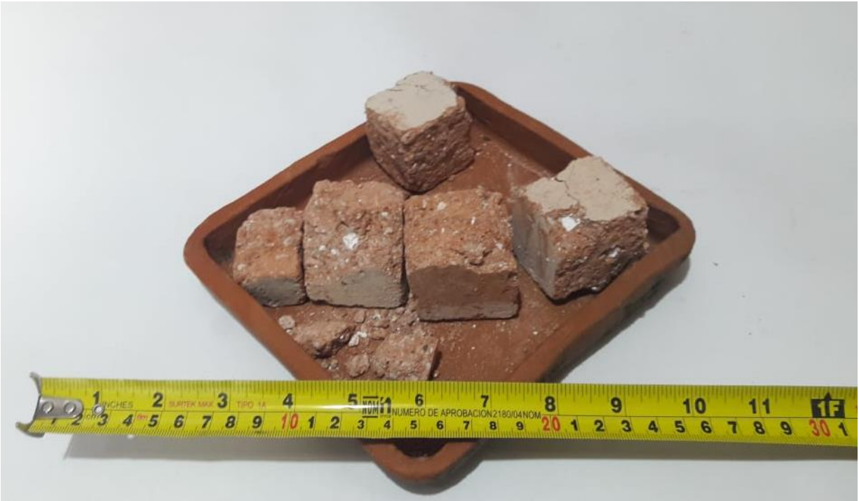
Figura 85: Muestras de mezcla 4 procesadas en mufla de laboratorio Fuente: Imagen propia
