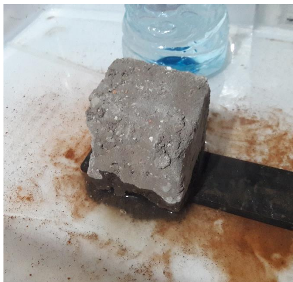
Figura 84: Ensayo de absorción inicial Fuente: Imagen propia
