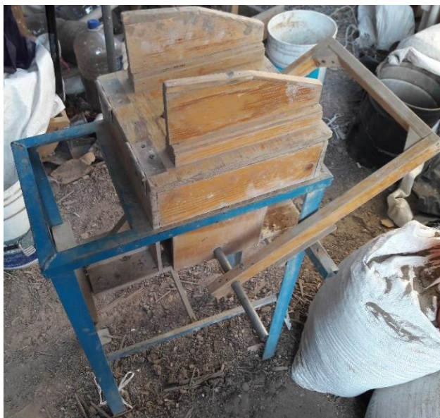
Figura 51: Ladrillera artesanal fabricada en el Instituto de Ingeniería por el grupo de valorización de RSU Fuente: Imagen propia
