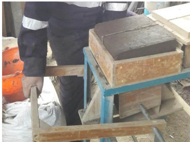
Figura 54: Obtención de ladrillos Fuente: Imagen propia
