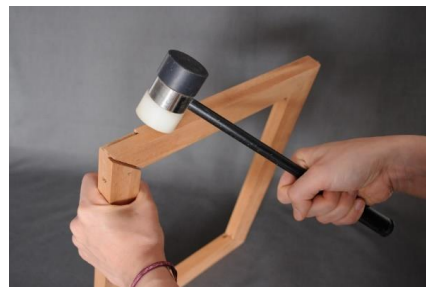
Ensamblado del bastidor de cedro con martillo de goma.
