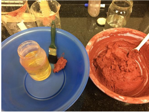
Pigmento rojo-óxido (almagre) y carbonato de calcio en mezcla con cola de conejo.
