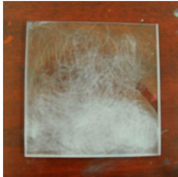
Lámina de PMMA al inicio del proceso de lijado.
