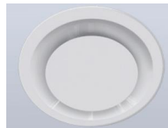
DIFUSOR ARQUITECTONICO REDONDO TIPO PLACA. PARA INYECCION O RETORNO. DIAMETRO EXTERIOR DE 25". CUELLOS DE 6 A 14"
