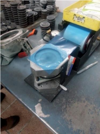
Figura 2.2. Dispositivo utilizado para bloquear la lente oftálmica.
