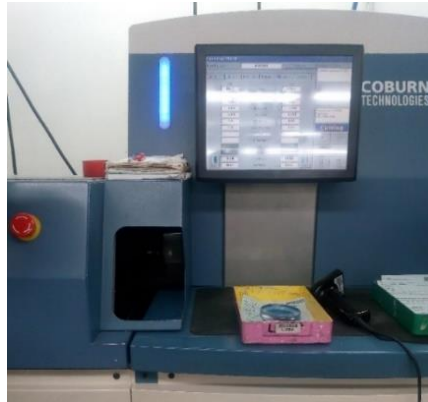
Figura 2.4. Máquina utilizada en la operación de generado.
