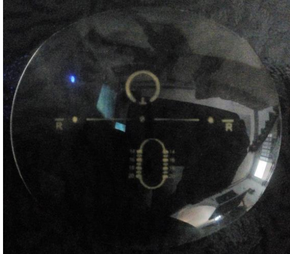
Figura 2.14. Marcas de referencias temporales en una lente oftálmica.
