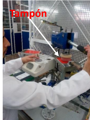
Figura 2.12. Representación de la forma correcta de entintar el tampón.
