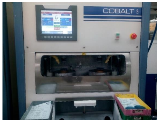
Figura 2.5. Máquina con la que se realiza el proceso de pulido.
