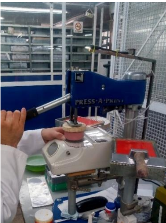
Figura 2.13. Impresión de los puntos de referencia en una lente oftálmica
