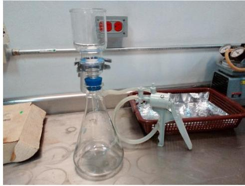
Figura 7 Sistema de filtrado con bomba de succión manual para colecta de clorofila *a*
