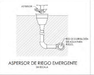
**PLANTA DE INSTALACIÓN DE RIEGO**
