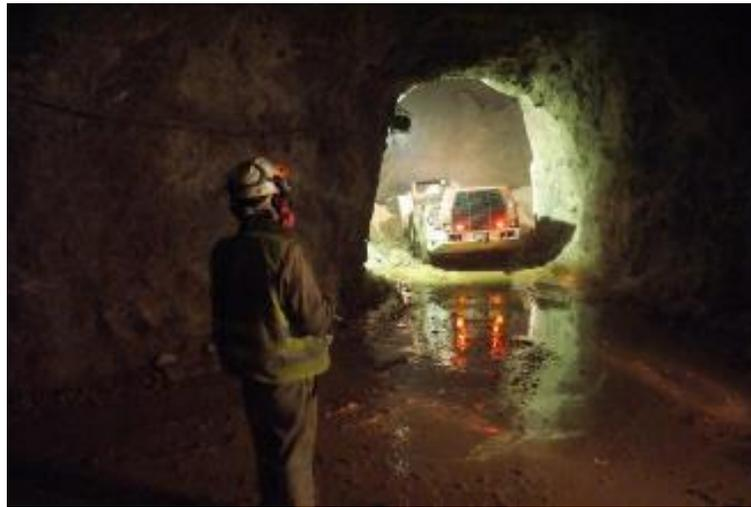
*Ilustración 7. Sistema de rezagado a control remoto*
