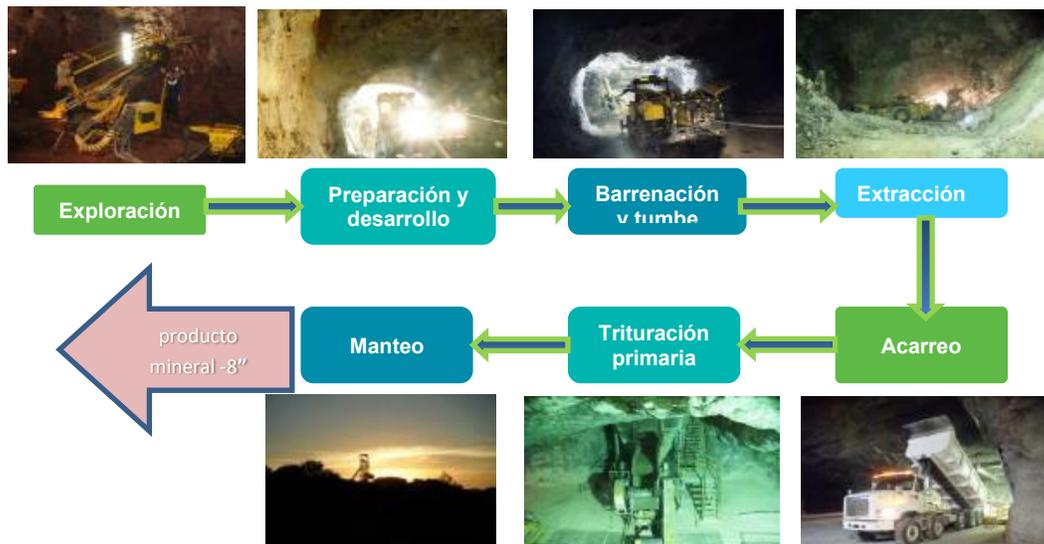
*Ilustración 10. Diagrama de flujo del sistema de minado*
