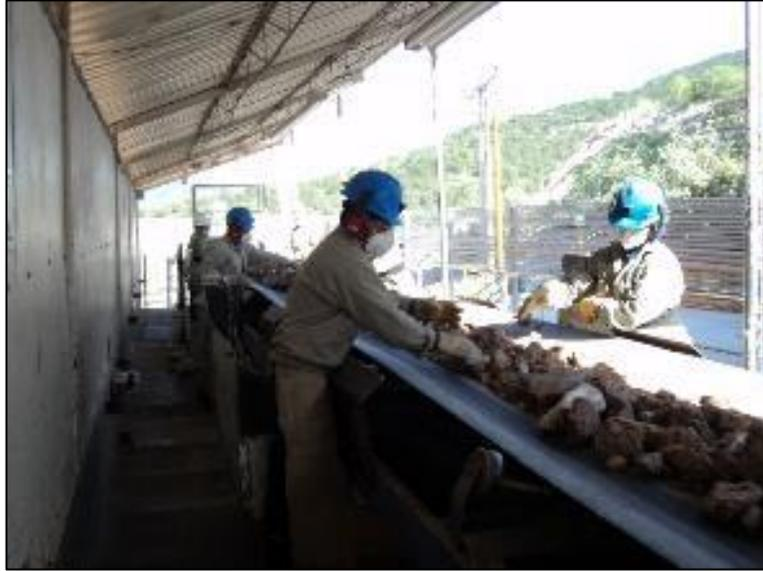
*Ilustración 11. Clasificación manual de impureza*
