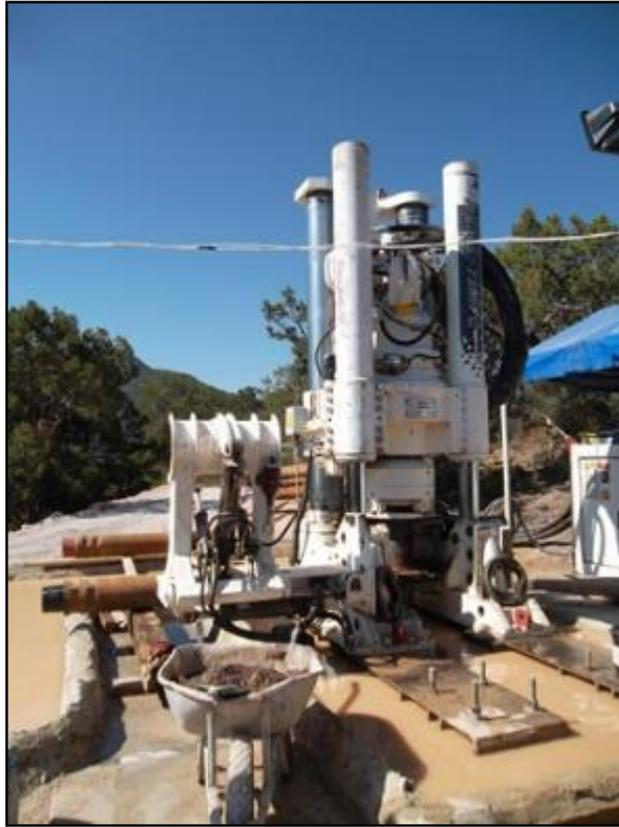
*Ilustración 24. Perforación y toma de muestra de lodo*
