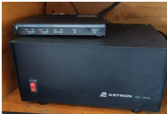
Figura 3.4: TNC Kantronics Packet Communicator 9612+ y fuente de poder Astron RS-35A
