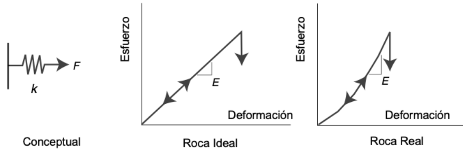
Figura 2.10: Ilustración de la ley constitutiva elástica. En la figura izquierdo se muestra un modelo físico análogo, en el centro, modelos de roca ideal y en la derecha, modelos de roca real. (Zoback, 2007)
