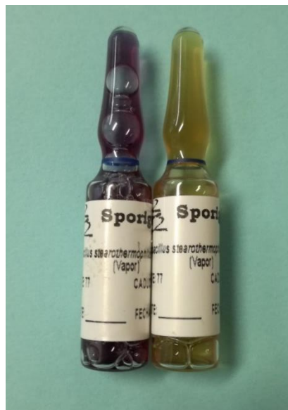
Figura 20. Fotografía de las esporas empleadas; ampolleta color morado: proceso de esterilización correcto, ampolleta color amarillo: proceso de esterilización incorrecto.
