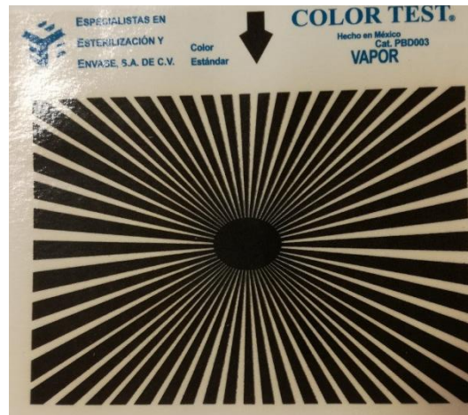
Figura 30. Prueba Bowie Dick después del ciclo de esterilización.
