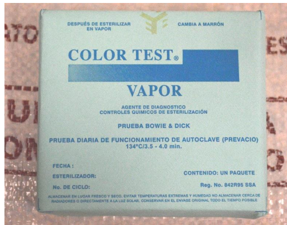
Figura 27. Prueba Bowie Dick antes de empezar ciclo de esterilización.
