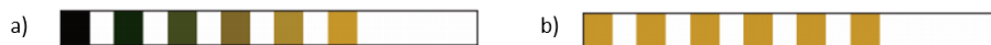
Figura 25. a) Insuficiente extracción de aire y penetración de vapor, b) Efecto de la temperatura sin extracción de aire ni penetración de vapor.
