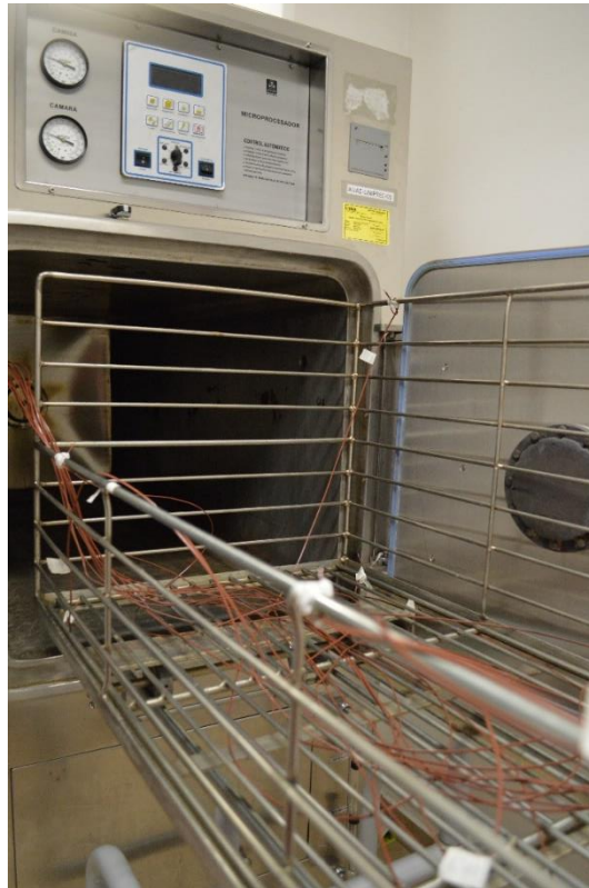
Figura 17. Fijación de termopares dentro de la rejilla.
