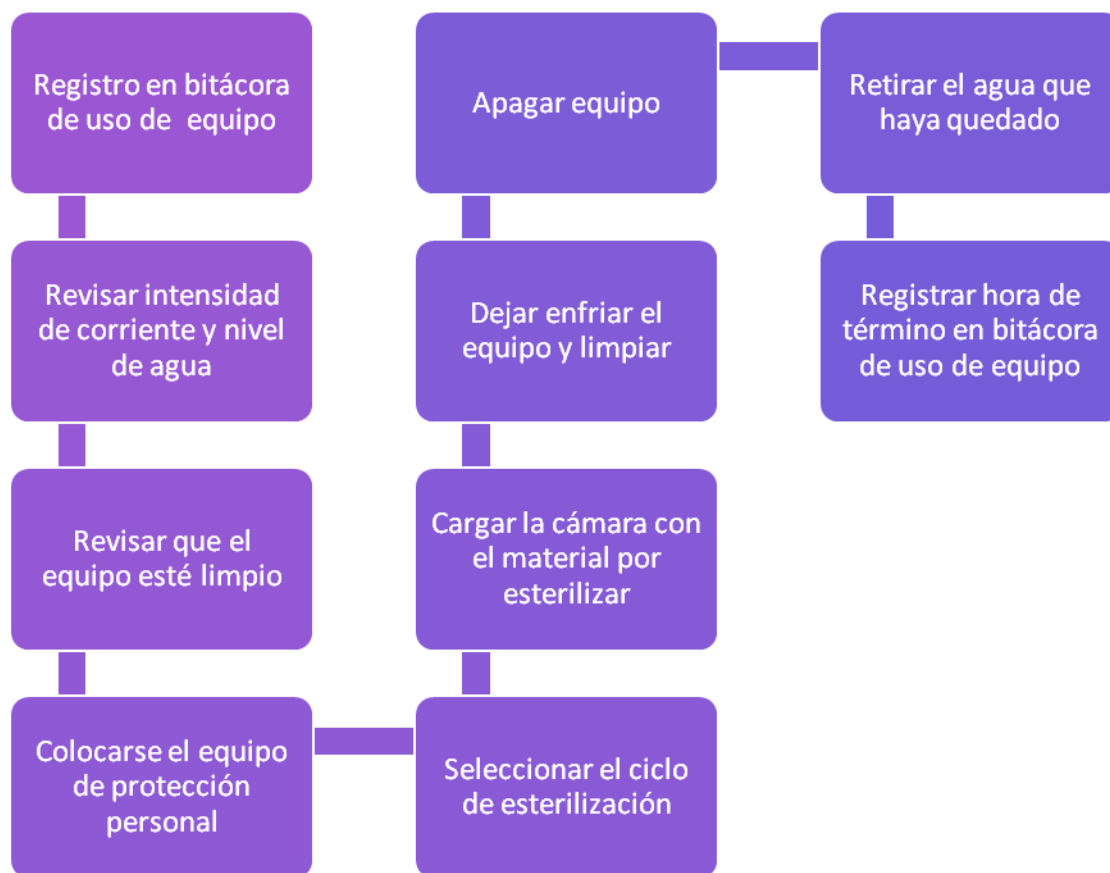
Diagrama 3. Pasos por seguir para operar la autoclave, el inicio y el final involucra el uso de la bitácora de uso del equipo, se consideran aspectos importantes de la operación correcta de la autoclave, así como del cuidado del personal que la opera.
