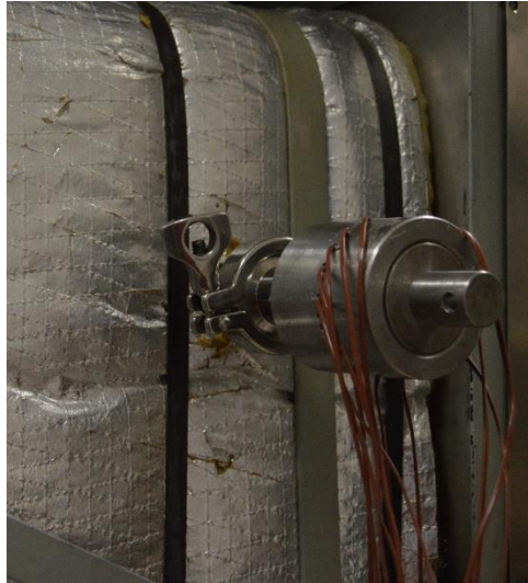
Figura 15. Colocación de termopares con entrada clamp.
