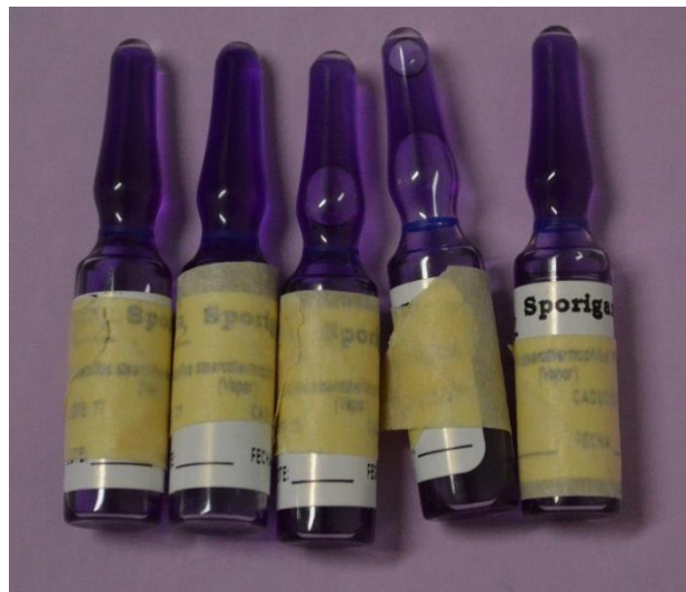
Figura 21. Ampolletas con cinta testigo, antes de empezar el ciclo de esterilización.
