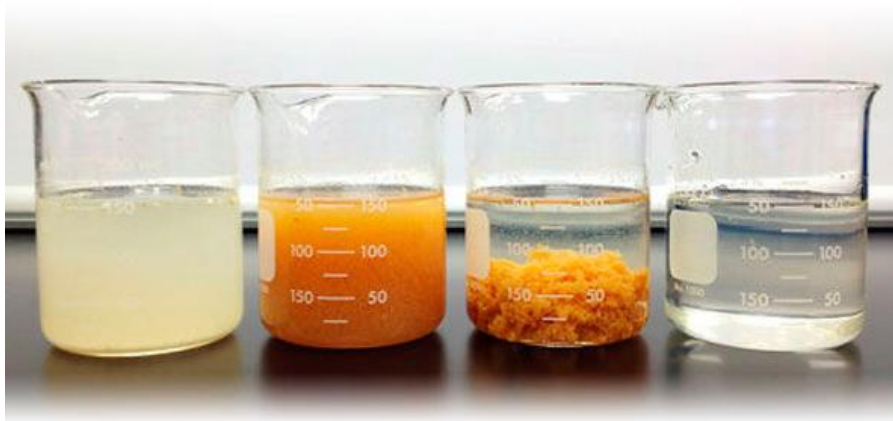
Figura 10. Ejemplificación del proceso de coagulación-floculación. Fuente: BIOQUIMIA, 2022.
