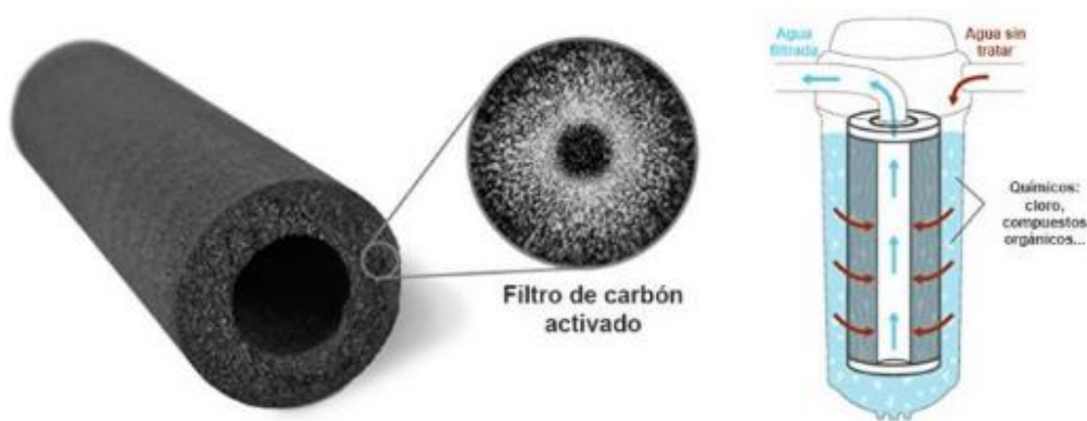
Figura 44. Filtro de carbón activado.
