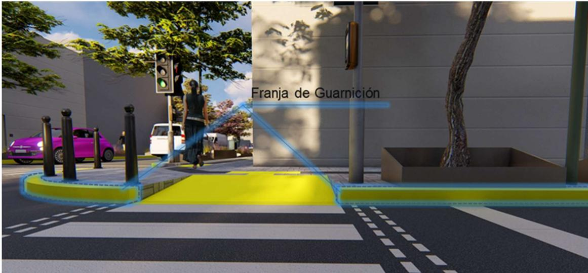
Figura 43. Tabla D Franja de Guarnición - Ejemplo, Elaboración propia con datos del Manual de Normas Técnicas de Accesibilidad.
