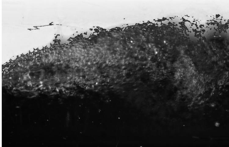
Figura 3.24. Resultado del procedimiento de edición de imágenes definiendo la superficie libre del agua.
