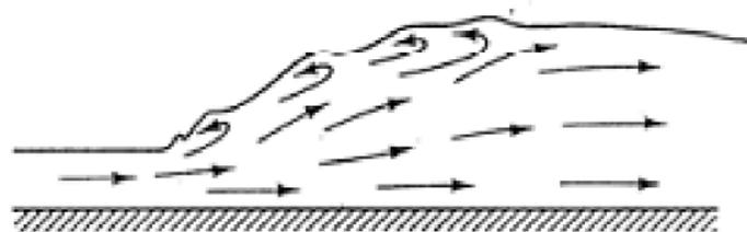
Figura 2.5. Resalto permanente o estable.
