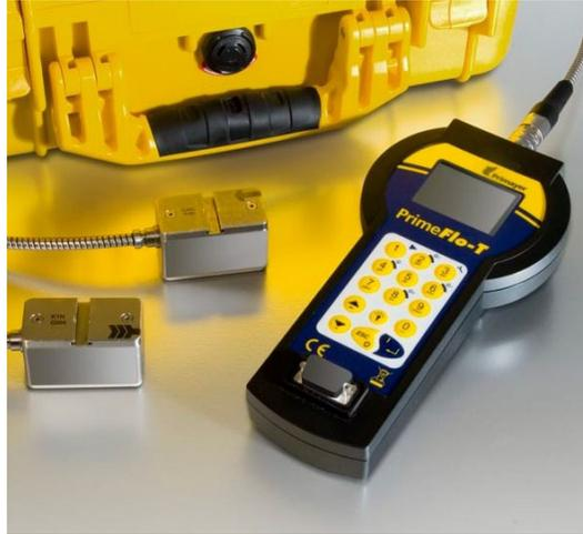
Figura 3.10. Medidor de caudal ultrasónico.
