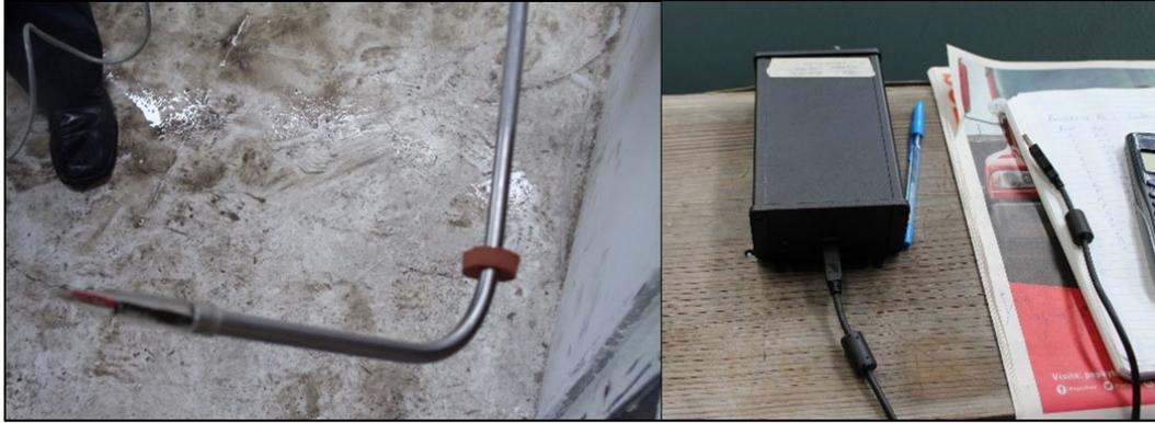
Figura 3.6. Sonda de conductividad de doble punta y caja con tarjeta electrónica.
