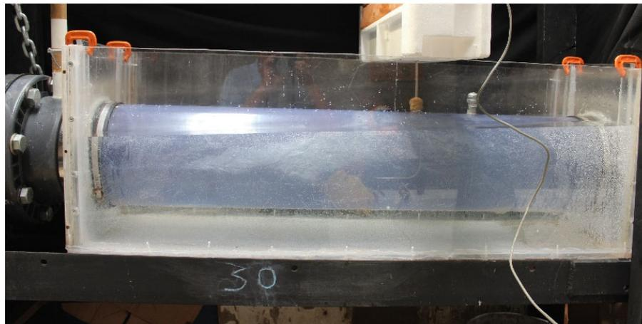
Figura 3.3. Caja de acrílico transparente (pecera) colocada en la sección de las mediciones.
