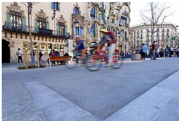
Img 70 Revista DC (2015) Imagen del conjunto de pavimentos sobre Paseo de Gracia. Rodamiento de asfalto, con guarniciones modulares y tratamiento peatonal de loseta hexagonal de hidrocemento. Recuperado: https://www.disenodelaciudad.es/pavimento-gracia-barcelona/
