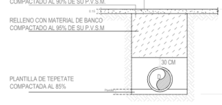
REGISTRO - EN PAVIMENTO DE CONCRETO HIDRÁULICO
