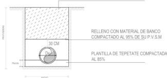
REGISTRO - EN TERRACERÍA
