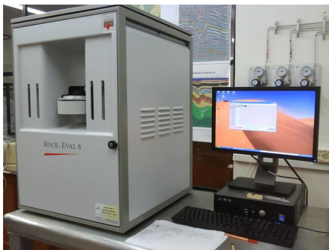
Figura 4.9. Equipo Rock Eval modelo 6 turbo usado para caracterizar la materia orgánica de las muestras analizadas en este trabajo.
