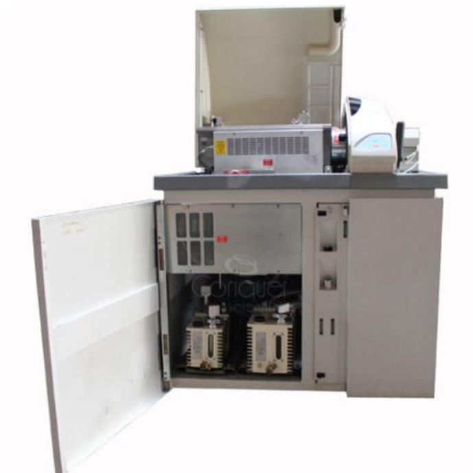
Figura 4.10. Espectrómetro de masas Perkin Elmer Sciex Elan 6100 utilizado para determinar la composición química de las muestras analizadas en este trabajo.
