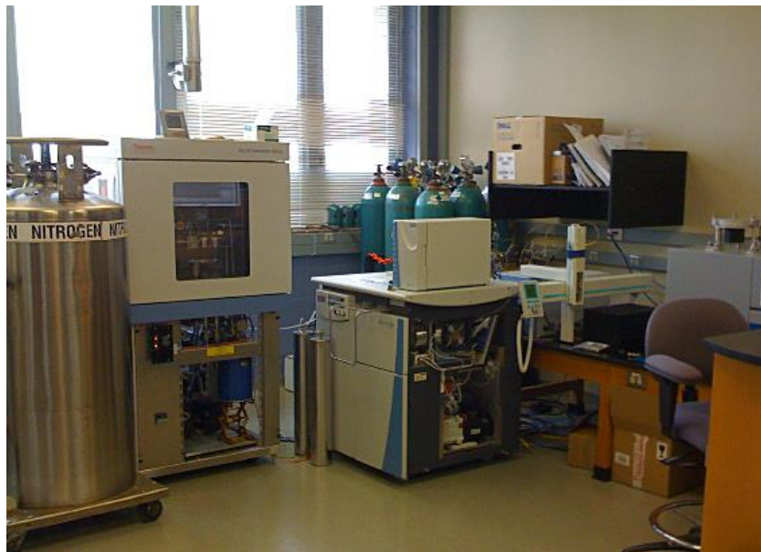
Figura 4.11. Espectrómetro de masas de relaciones isotópicas ThermoFinnigan Delta V utilizado para determinar la composición isotópica de carbono de la materia orgánica de las muestras analizadas en este trabajo.
