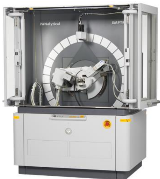
Figura 4.7. Difractómetro de rayos X EMPYREAN usado para determinar la composición mineral de las muestras estudiadas en este trabajo.
