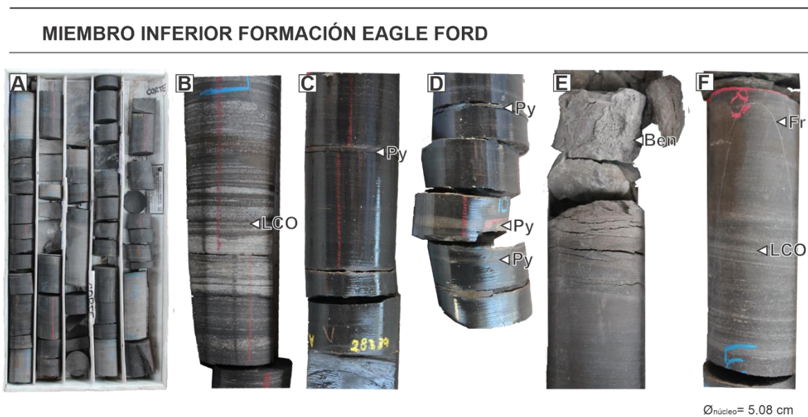
Figura 5.2. Fotografías de los principales rasgos sedimentológicos del Miembro Inferior de la Formación Eagle Ford: A -Intercalación de caliza y lutita, B -Laminación plano-paralela, note la alternancia de láminas claras y oscuras, C -Lutita carbonosa con láminas de pirita, D -Láminas de pirita, E -Horizonte de bentonita, F -Fractura rellena de calcita. LOC: laminas claras y oscuras, Py: pirita, Ben: bentonita, Fr: fractura rellena de calcita.
