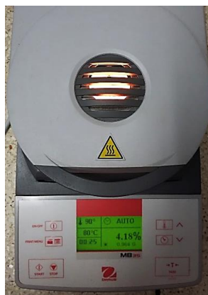
Figura 19: Termobalanza Ohaus MB35 utilizada para la determinación de humedad de pericarpio y almendra de semillas de chincuya.
