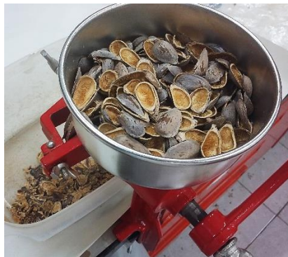
Figura 20: Molienda de pericarpio de semilla en molino manual marca Estrella.
