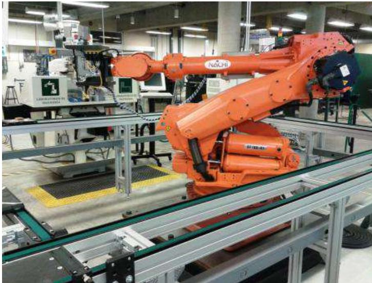
Figura 2.1: Fotografía de una celda de manufactura: brazo robótico y bandas de transporte (ITAM, 2019).
