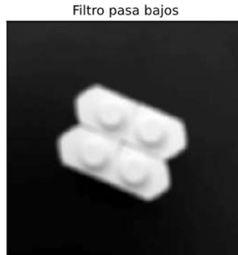
Figura 4.10: Fig. 4.9 con filtro gaussiano.
