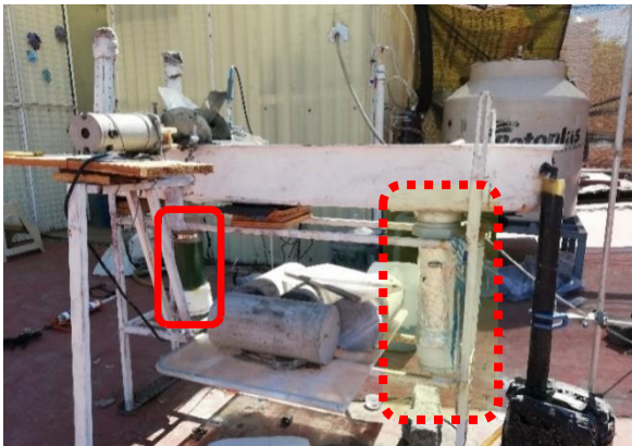
Fig. 3.5 Pozos de desorción de OD en el HRAP
