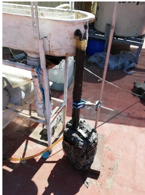
Fig. 3.3 Columna abierta empacada colocada en el efluente del HRAP
