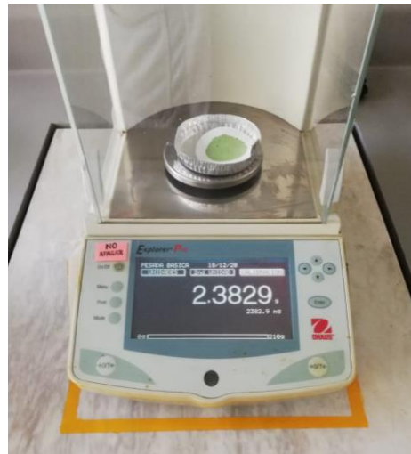
Fig. 3.10 Filtro Whatman con biomasa seca (SST)
