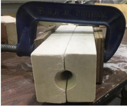
Finalmente, se unieron ambas mitades. Se revisó que estuvieran perfectamente alineadas donde se vaciaría el metal líquido, se les colocaron tablas en los extremos y se les colocó una pinza de presión grande para sujetarlas sin romper el molde (Figura 15).
