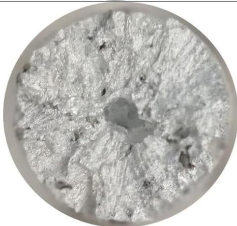
Probeta con 9 minutos de desgasificado (Pieza C).
