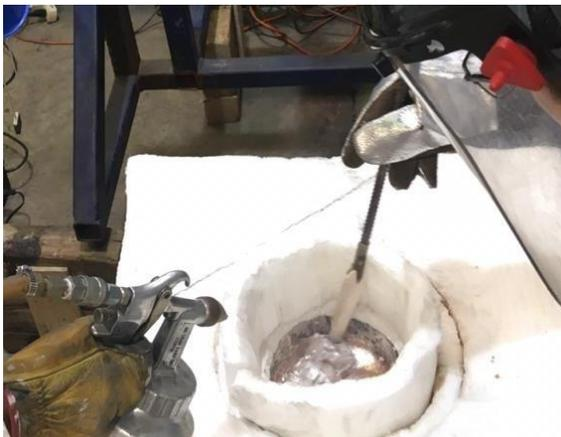
*Figura 17. Agitación y atomización de agua precalentada en el aluminio líquido.*
