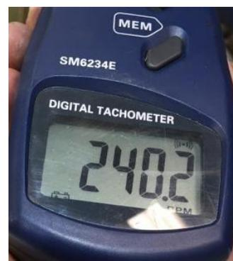
Figura 19. Velocidad de rotación del rotor con un tacómetro digital Marca MEM.
