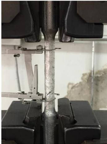
*Figura 25. Inicio de fractura en la pieza E.*
