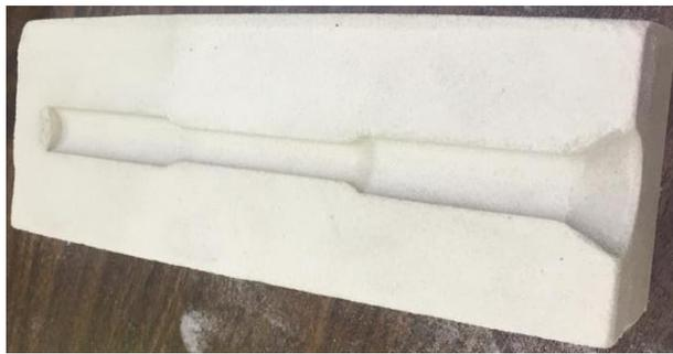
*Figura 14. Ejemplar de molde de silicato - CO<sub>2</sub>.*
