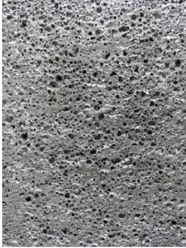
*Figura 3. Porosidad macroscópica sin tratamiento de remoción en piezas de aluminio provenientes de fundición.*
