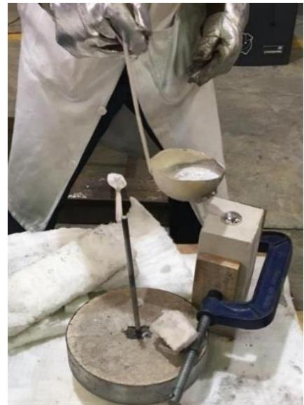
*Figura 20. Obtención de probetas de tensión.*
