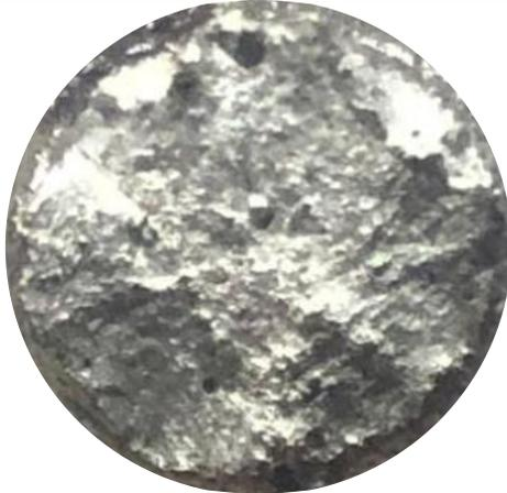
Desgasificado 12 min (Pieza L)
