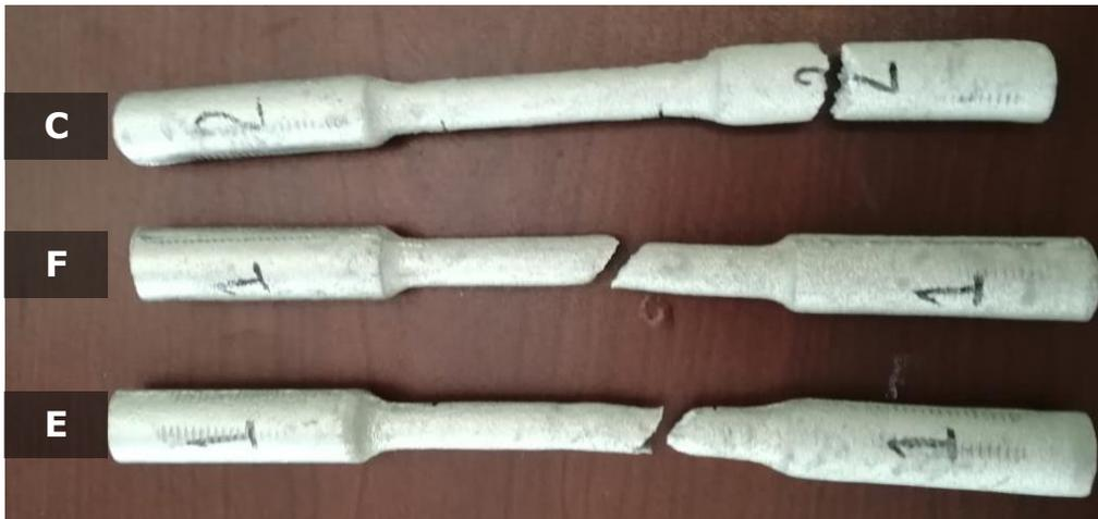
*Figura 24. Zona de fractura de las piezas C, E y F.*
