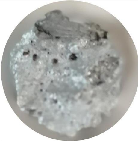
Probeta con 12 minutos de desgaseado (Pieza E).
