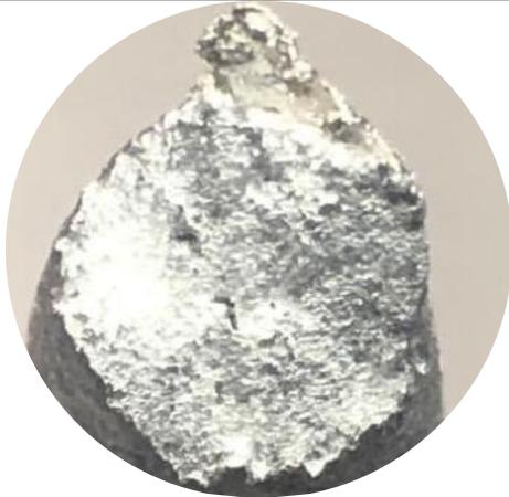
Desgasificado 12 min (Pieza J)
