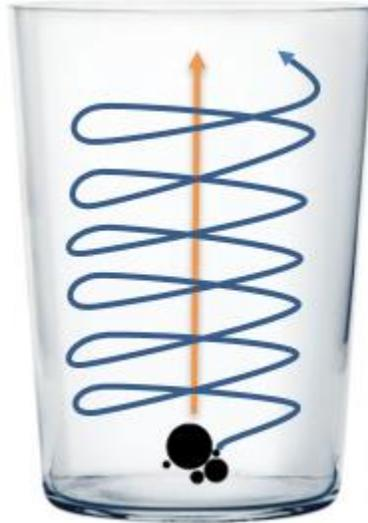
*Figura 8. Representación de las fuerzas boyantes (naranja) y las fuerzas inerciales (azul) experimentadas por las burbujas de gas de purga – hidrógeno en el proceso de desgasificado.*
