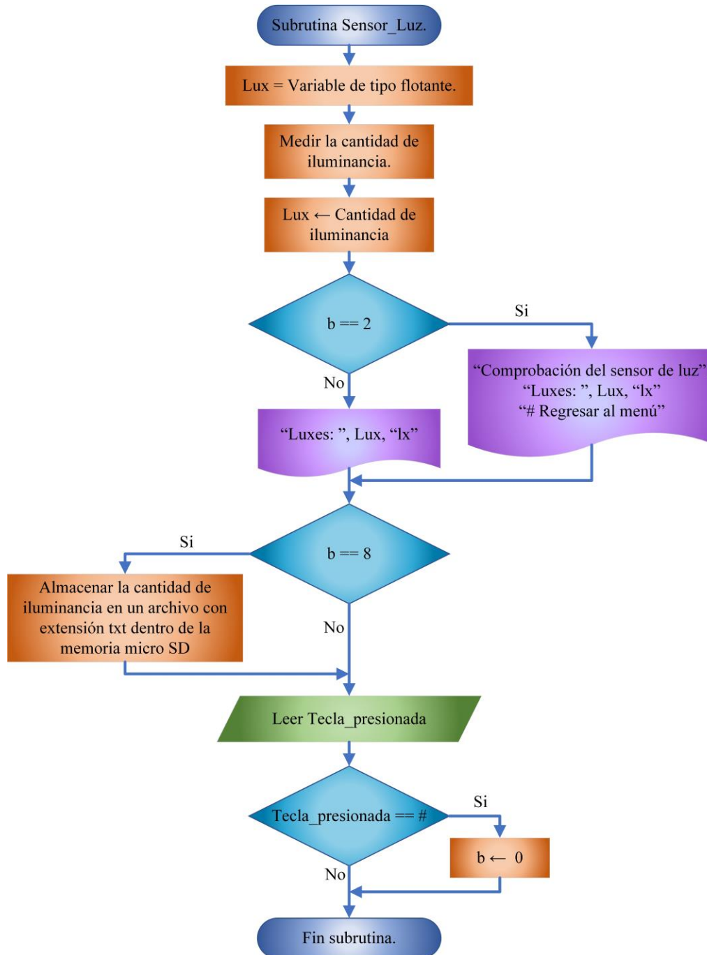
Figura 2.53 Diagrama de flujo empleado en la subrutina para la medición de la cantidad de iluminación.
