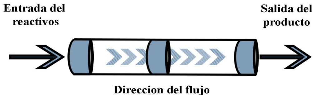
Figura 1.2 Representación esquemática de un reactor de flujo en pistón.
