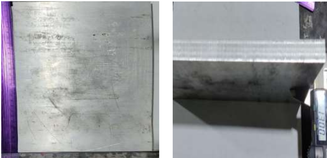
Figura 12. Planchón inicial de la aleación 7075
