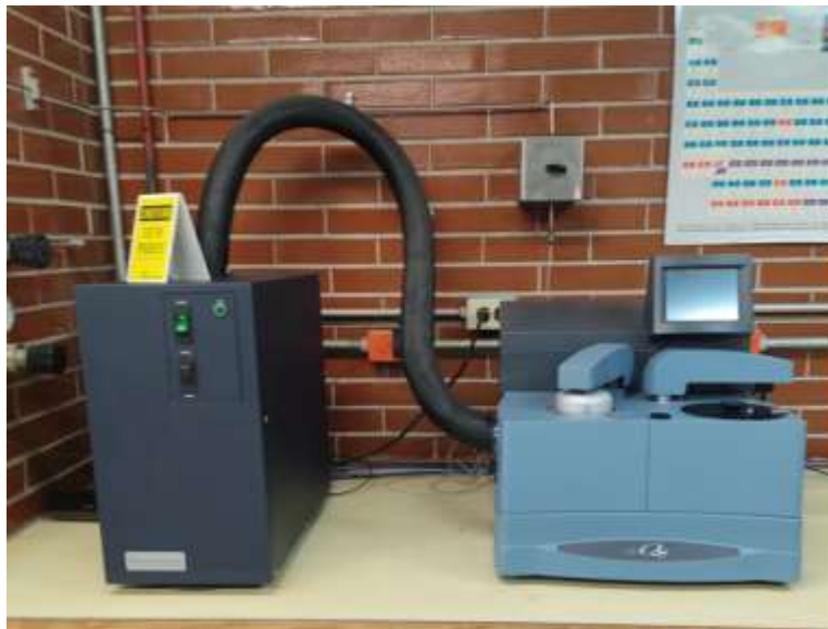
Figura 23. Calorímetro TA Instruments modelo DSC Q100 V9.8
