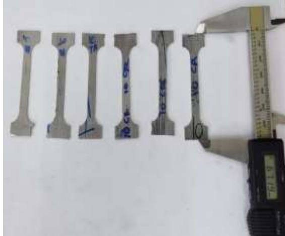
Figura 24. Muestras sometidas a prueba de tracción.
