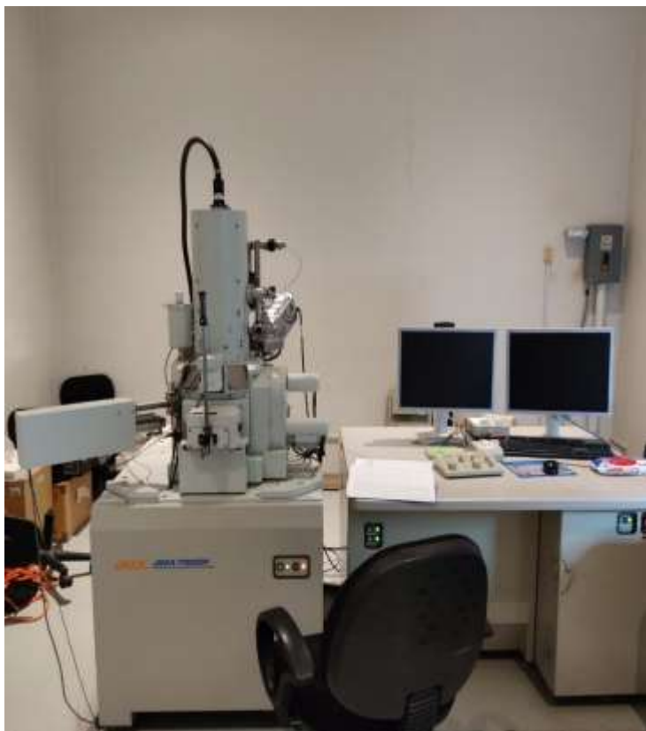
Figura 22. Microscopio electrónico de barrido JOEL JSM 7600F del instituto de investigación en materiales
