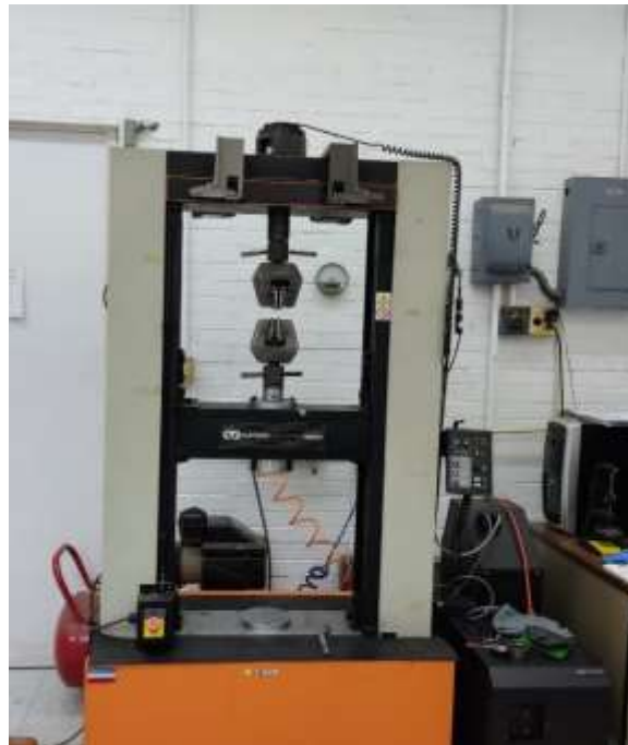
Figura 26. Equipo de prueba de tensión INSTRON 5500R del instituto de investigación en Materiales
