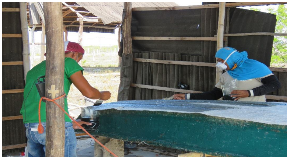
Figura 3.9 Reparación de embarcaciones en la línea de costa Sisal
