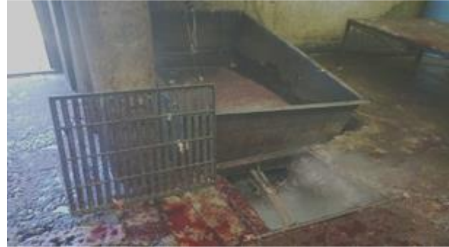
Vaciado del agua del tanque de escaldo sobre rejilla de drenaje.
