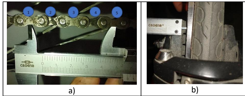
Figura 31 a) Medición de holgura en cadena b) Medición de espesor en gomas
