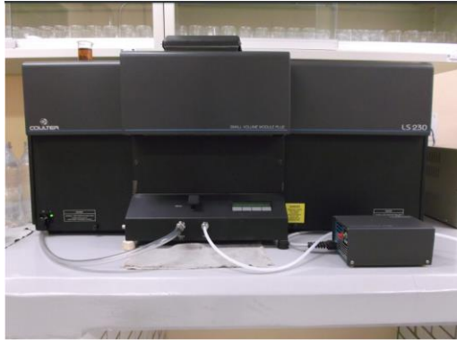
Anexo 1. Analizador Laser Marca Coulter Modelo 230. Obtenida de informe de actividades Julio 2018-Junio 2019 ICML
