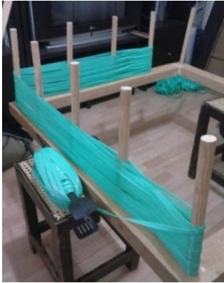
Figura 48. Tendido de urdimbre de 127 cm.
