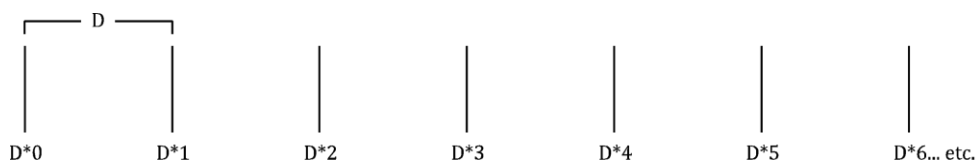
Ilustración 29: distribución homogénea mediante múltiplos de D .
