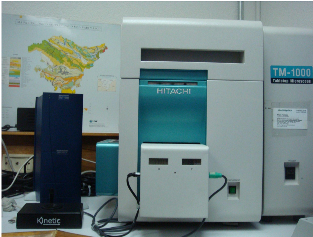
Figura 3.2 - SEM portátil TM-1000 ubicado en el Laboratorio de Petrografía y Microtermometría del Departamento de Recursos Naturales del Instituto de Geofísica, UNAM.
