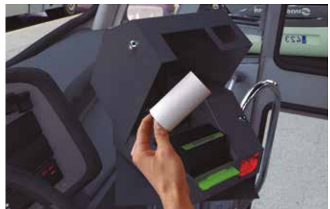
Fig. 92. El operador puede cambiar el rollo de la impresora, pero no tiene acceso a los demás componentes. El rollo vacío se reemplaza con facilidad. Fuente propia.
