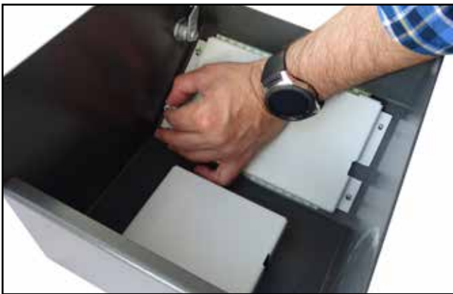
Fig. 3. Coloca la pieza Soporte Pantalla en los tonillos inserto de la parte inferior de la pieza Tapa, como lo muestra la imagen. Fuente propia
