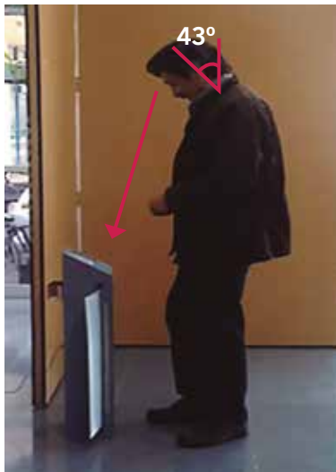
Fig. 66. La estatura del usuario es de 175 cm. El usuario se acercó al prototipo y leyó la información en la tableta, su ángulo de visión es de 43° en referencia con su plano sagital. Fuente propia.
