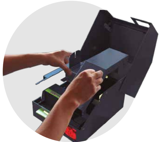
Fig. 97. Debajo de la cubierta existe un espacio para almacenar todos los cables, éste facilita al técnico su maniobra (ver figura 5, página 106). Fuente propia.
