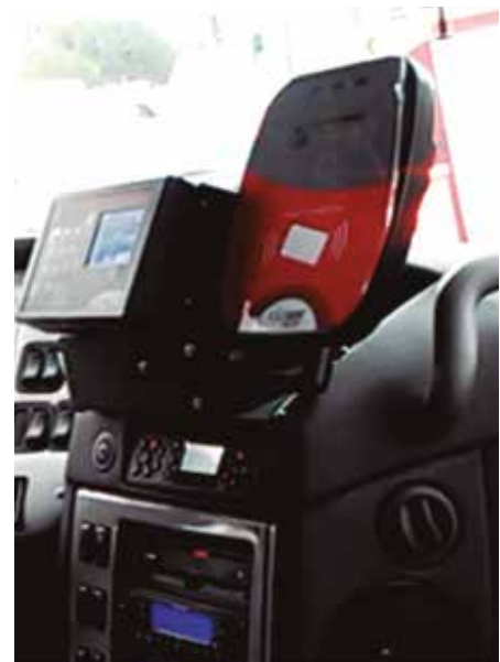
Fig. 31. Boletera para cobro de boleto en un autobús. Análisis de funcionamiento. Fuente propia.
