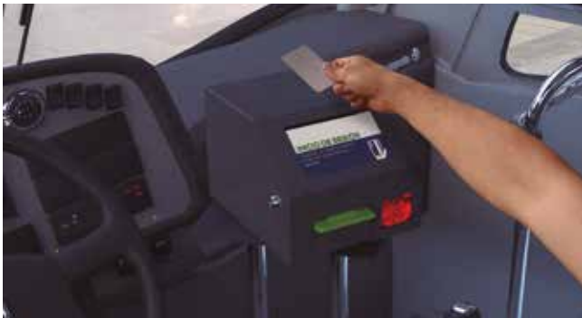
Fig. 83. El operador inicia y cierra sesión en el lector de tarjetas. Fuente propia.
