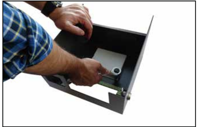
Fig. 2. Fijala con tuercas de \frac{1}{4} " con ayuda de la matraca. Fuente propia.
