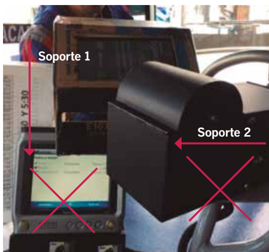
Fig. 77. Soportes actuales en cabina. Fuente propia.
