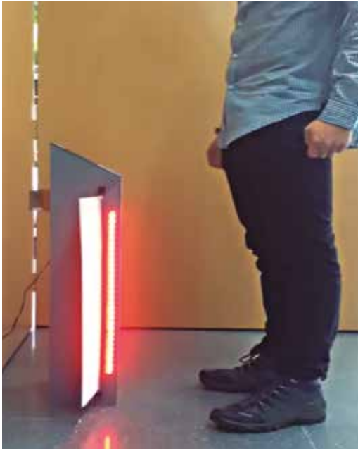
Fig. 61. Al pagar solo una parte del boleto, se enciende una luz roja acompañada de una voz que dice: "Denegado", que indica un acceso bloqueado. Se solicita cubrir la tarifa completa. Fuente propia.
