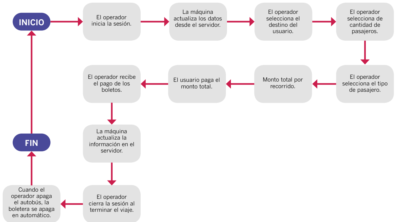
Fig. 74. Diagrama de flujo de máquina de boletera. Fuente propia.
