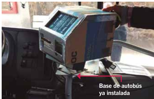
Fig. 69. Prototipo de Boletera en base de metal. Fuente propia.
