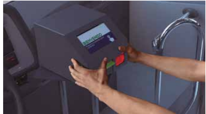
Fig. 82. El operador ajusta la boletería en dos ejes para tener una mejor visión de la pantalla. Fuente propia.
