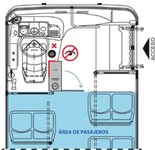
Fig. 45. El modelo obstruye visión lateral del operador. Fuente propia.
