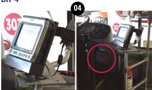
Fig. 4. BH-4. Boletera con componentes por separado. VERIF-ID. Monitor CV-31 C/IMPRESORA HONEYWELL PB31. Fuente propia.
