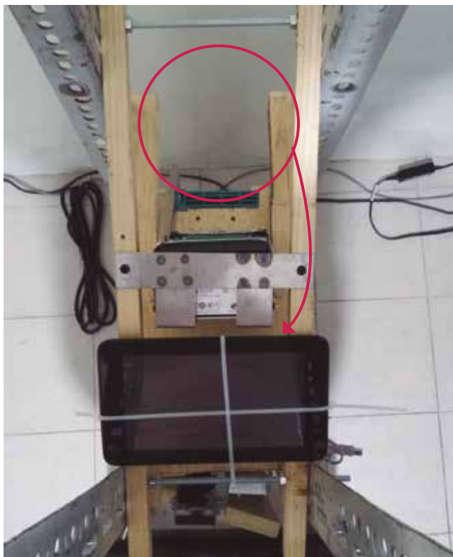
Fig. 23. Reubicación de tableta. Al mover los componentes, se pudo recorrer la tableta hacia abajo, lo que permite al usuario un mejor alcance. Fuente propia.
