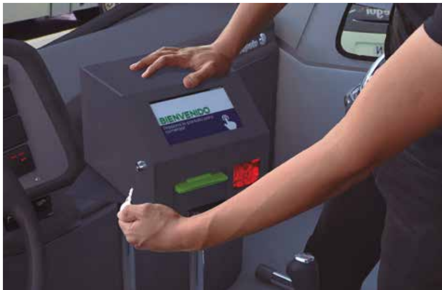
Fig. 95. El técnico tiene que abrir la primera chapa y levantar la tapa para acceder sólo a la impresora. Fuente propia.
