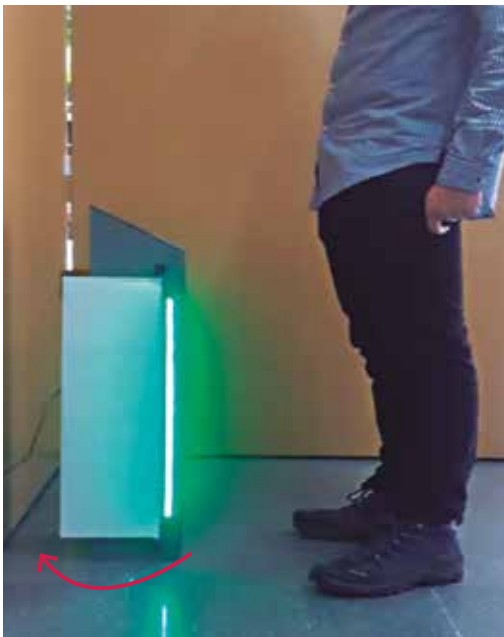
Fig. 63. Al cubrir el total de la tarifa, se enciende una luz verde acompañada de una voz que dice: "Acceso permitido". La puerta de acceso se abre para darle el paso al usuario. Fuente propia.
