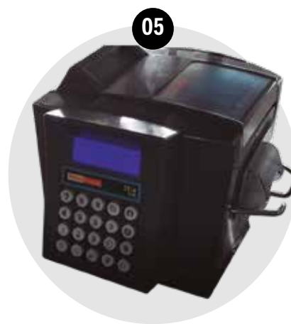
Fig. 5. BH-2. Boletera idéntica a BH-2. Tecno-Acción. Boletera TC-6. Fuente propia. Esta boletera actualmente opera en varios autobuses.
