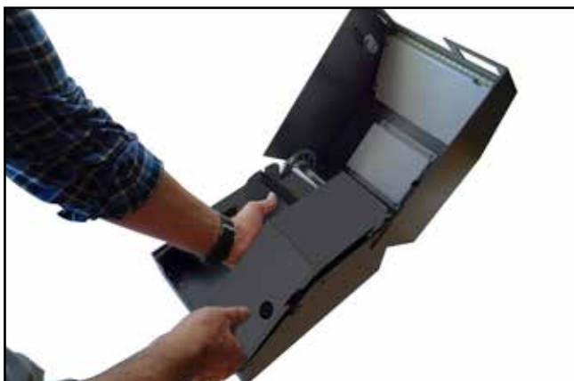
Fig. 11. Posiciona la pieza Cubierta en la pieza Base. La pieza Base cuenta con un doblez que sirve como guía para ensamblar la pieza Cubierta Fuente propia.
