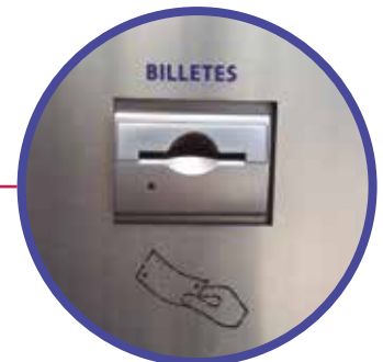
Fig. 66. Lector de billetes. La estación de cobro cuenta con aceptador de billetes. Fuente propia.
