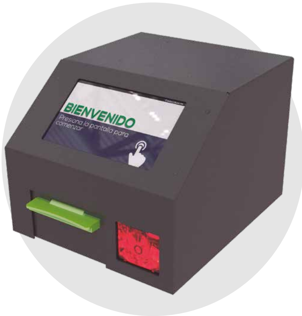
Fig. 6. Boletera. Render final de boletera. Fuente propia
