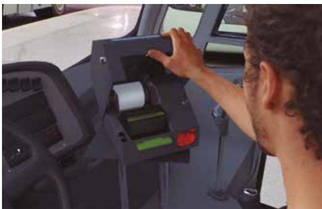
Fig. 91. Para tener acceso a la impresora (1ª área de seguridad), el operador debe levantar la cubierta principal. Fuente propia.
