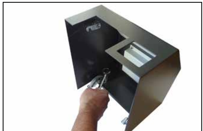
Fig. 6. Coloca las bisagras en la pieza Tapa en los tornillos inserto, como se muestra en la imagen y fíjalas con tuercas con la ayuda de la matraca con dado de \frac{1}{4} ". Fuente propia.
