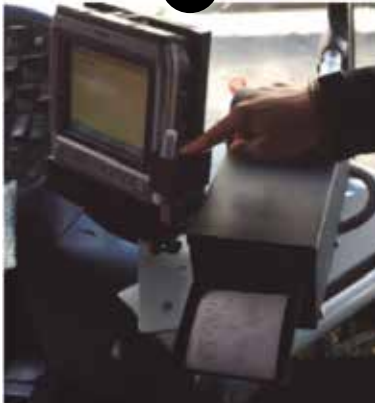
Fig. 6. BH-5. Boletera con componentes por separado. VERIF-ID. Monitor CV-31 c/ impresora ZEBRA KR403. Fuente propia.
