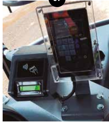
Fig. 7. BH-7. Boletera con componentes por separado. Tecno-Acción. Boletera TC-7 C/IMP VKP80II (CONTINUACIÓN DE LA TC-6). Fuente propia.
