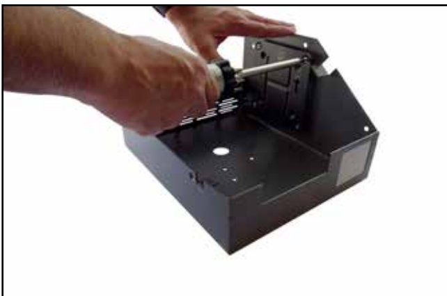
Fig. 5. Coloca la pieza Soporte CPU en los postes laterales de la pieza Base y atornilla la pieza con la ayuda de un desarmador de cruz. Fuente propia.
