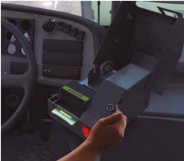
Fig. 96. Abre la segunda chapa y retira la cubierta para acceder a los demás componentes resguardados. Fuente propia.
