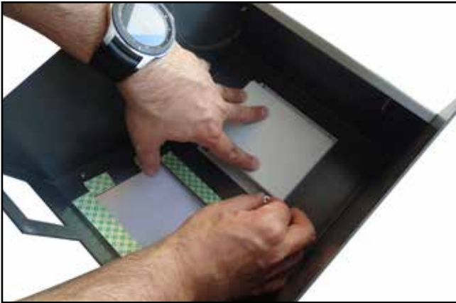
Fig. 1. Coloca en una superficie plana la Tapa, después coloca la pieza Soporte Lector de Tarjetas en los tornillos inserto en la parte superior de la pieza. Fuente propia.
