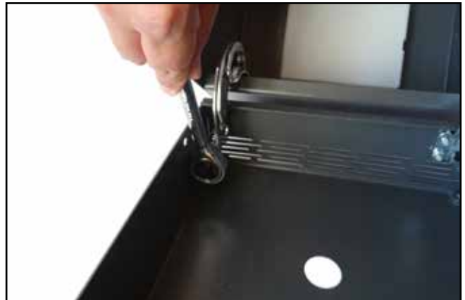
Fig. 8. Con ayuda de la matraca con dado de 1/4", termina de presionar las tuercas, como se muestra en la imagen Fuente propia.
