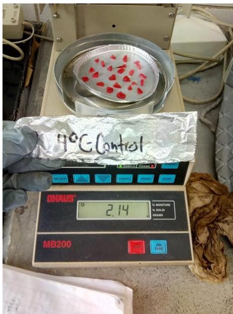
Figura A5.1. Determinación de humedad en termobalanza
