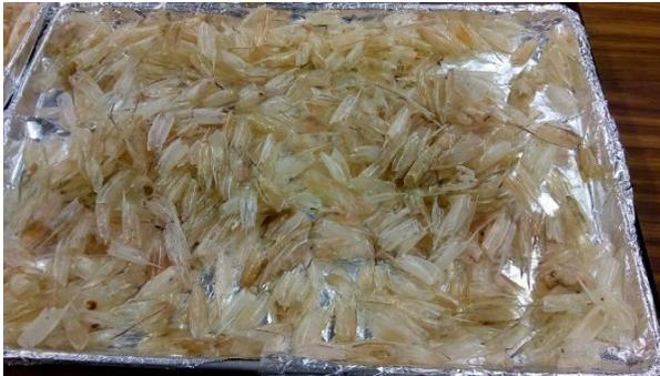
Figura 3.3. Secado de exoesqueletos de camarón en estufa a 60°C
